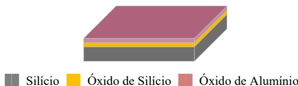
Figura-44: Amostra com óxido de alumínio depositado.
