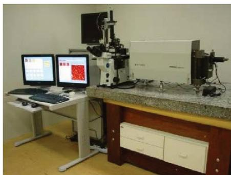
**Figura 22** – Equipamento Raman Spectroscopy AFM System, modelo NTEGRA Spectra, produzido pela empresa NT-MDT [25].
