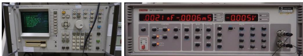
**Figura 29** – Semiconducter Parameter Analyzer da HP (à esquerda) e o CV Analyzer da KEITHLEY (à direita).
