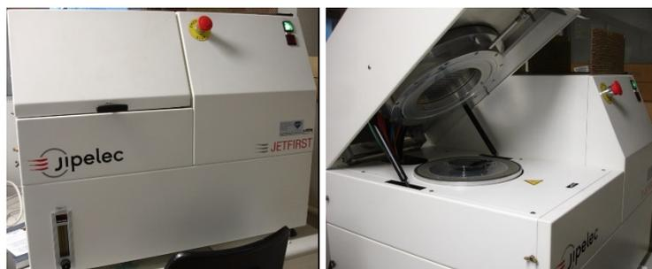
**Figura 21** – Equipamento de RTA localizado no CCS.
