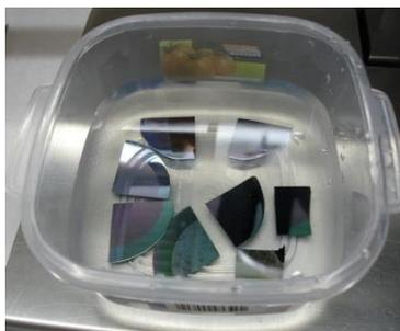
**Figura 17** – Amostras mergulhadas em água DI após a deposição de titânio para evitar a oxidação das lâminas.
