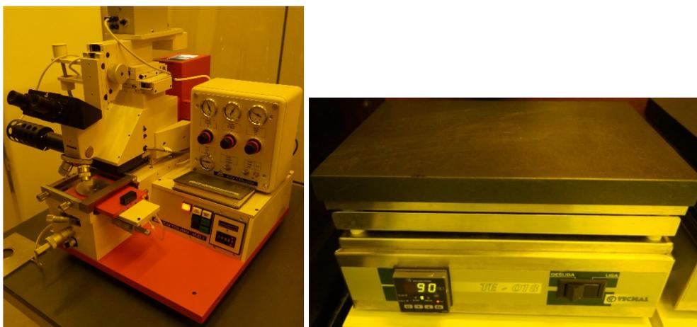
**Figura 25** – Foto alinhadora MJB-3 da marca Karl Suss (à esquerda) e o *hot plate* modelo TE-018 da marca TECNAL (à direita).
