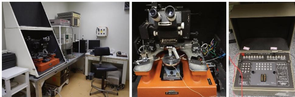
**Figura 28** – Observa-se a sala de medidas CxV (à esquerda), probe station (centro) e placa de controle (à direita).
