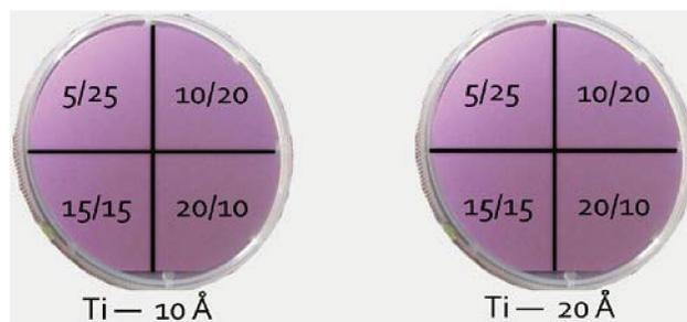
**Figura 14** – Ilustração mostrando a clivagem das lâminas de silício em quatro partes e a numeração usada como nomenclatura tendo como base a espessura do titânio depositado e as concentrações de gás  $N_2$  e Ar.
