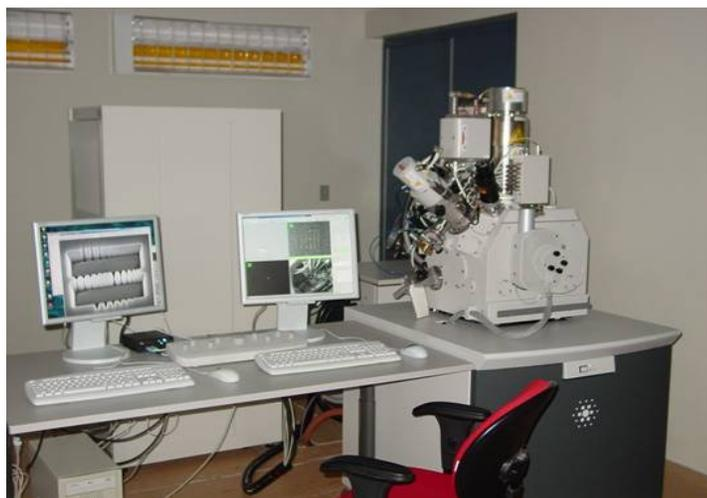
**Figura 24** – Sistema *Dual-Beam* (FIB-SEM) localizado no CCS [26].
