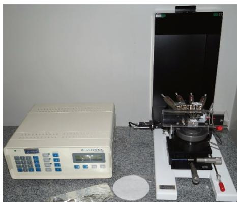
**Figura 23** – Equipamento de medidas 4 pontas localizado no CCS.
