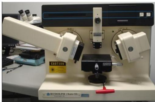
**Figura 13** – Elipsômetro da marca RUDOLPH, modelo XX 2,4C.
