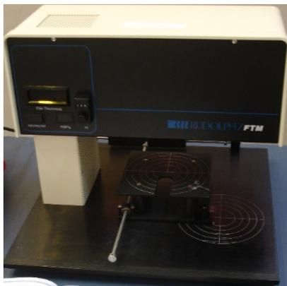
**Figura 12** – Interferômetro da marca RUDOLPH, modelo FTM-STD.
