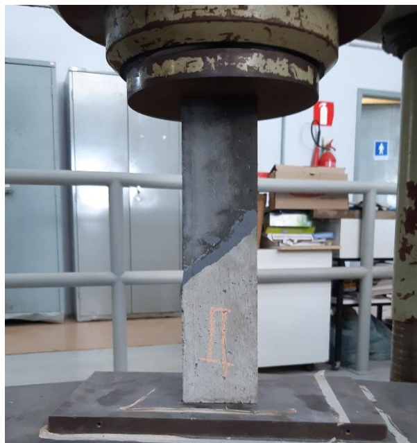
Figura 25 – esquema do ensaio slant shear test
