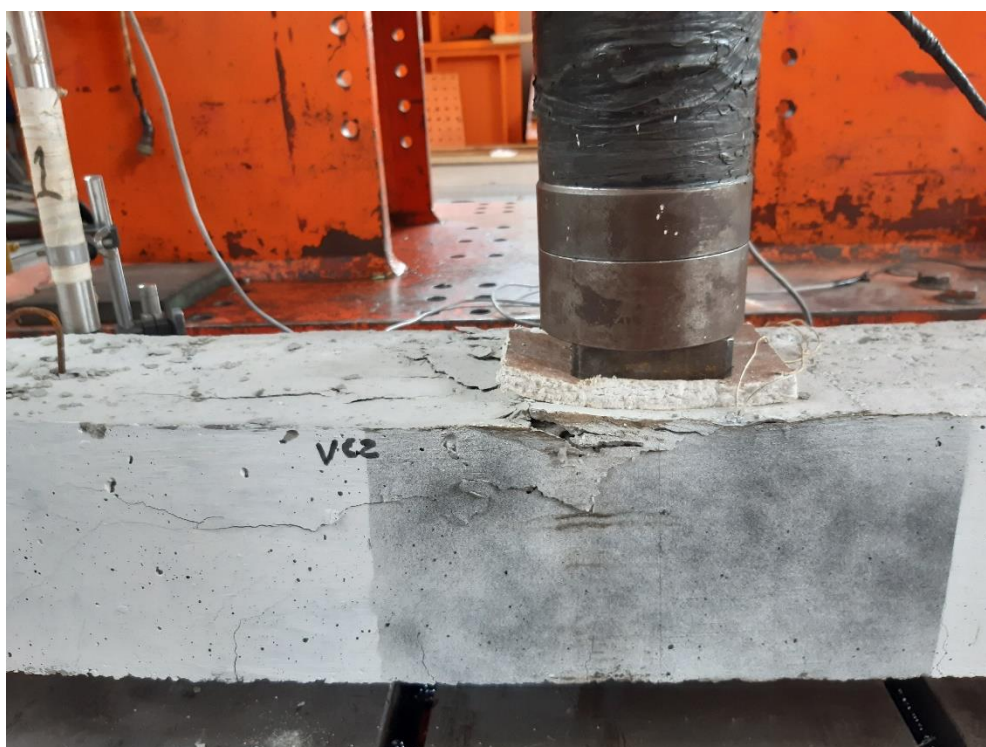
Figura 34 – ruptura típica da viga VC
