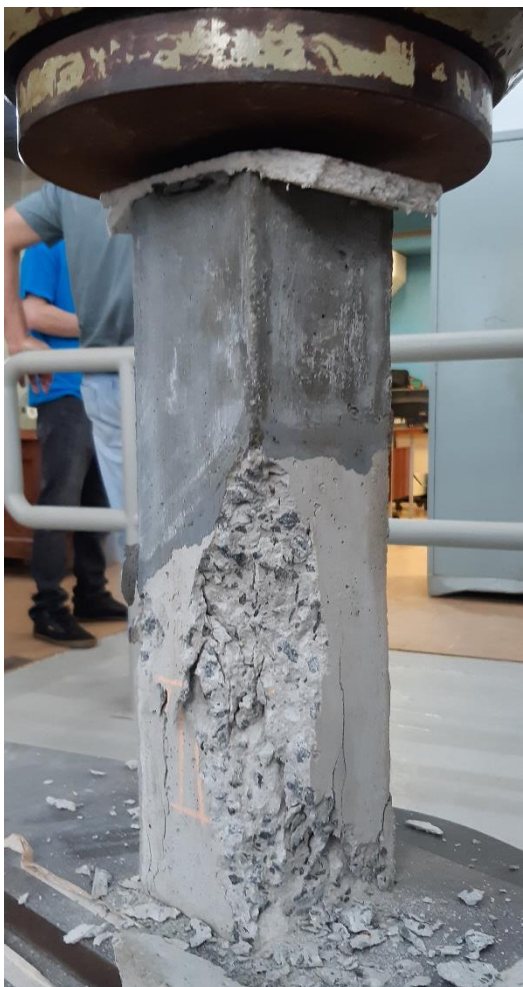
Figura 26 – falha típica por compressão do substrato
