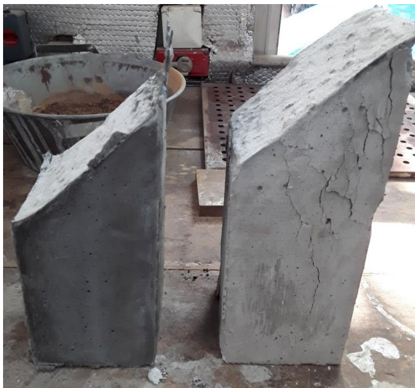
Figura 27 – falha típica do substrato
