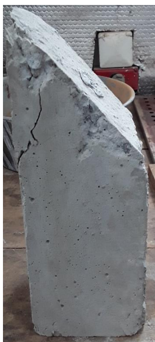
Figura 28 – falha mista típica
