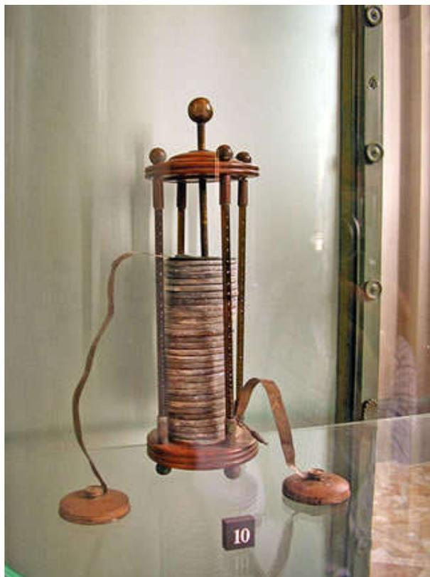
**Figura 14 - Pilha voltaica (FOGAÇA, 2017).**
