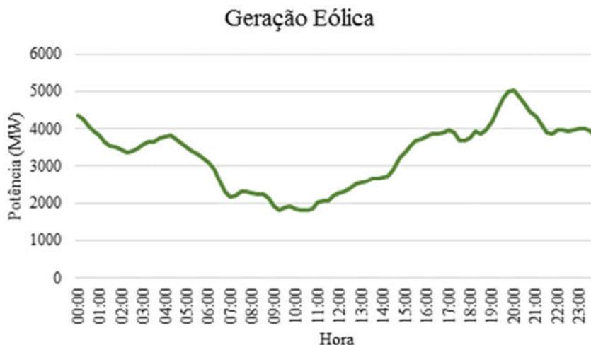
Figura 34 - Curva de geração eólica para simulações no modelo de planejamento de operação de curto prazo.
