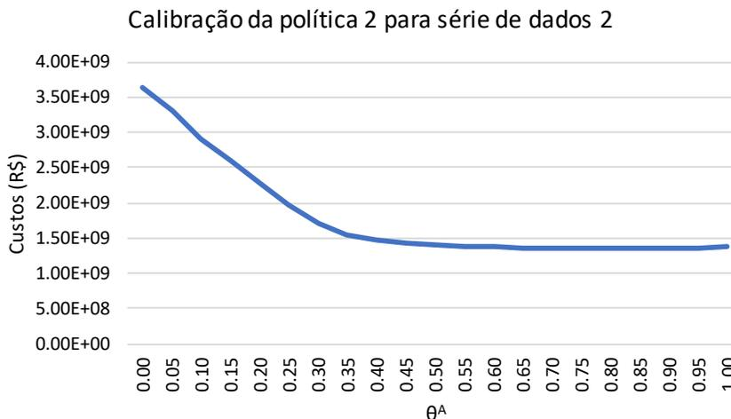
Figura 48 - Calibração da política 2 para  $P_{max}^{HD} = 2,0 \text{ GW}$  e  $R_{max}^A = 3,0 \text{ GWh}$ .
