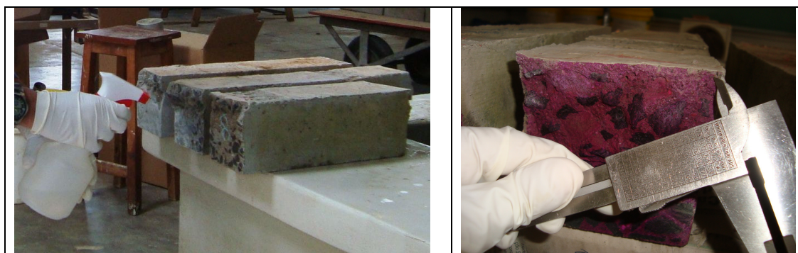
Figura 6.16 – Ensaio de profundidade de carbonatação aos 18 meses de idade.
