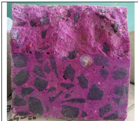
Figura 5.23 – Corpo-de-prova com solução de fenolftaleína, pronto para a leitura de profundidade de carbonatação.
