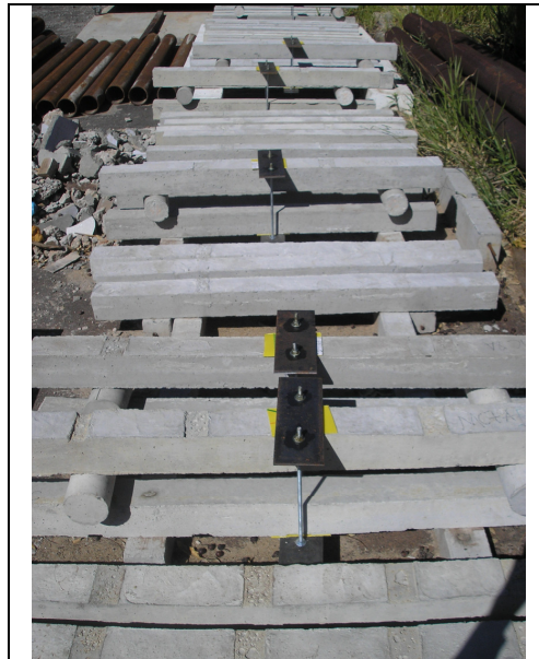
Figura 5.21 – Corpos-de-prova prismáticos carregados e não carregados, expostos ao ambiente externo.
