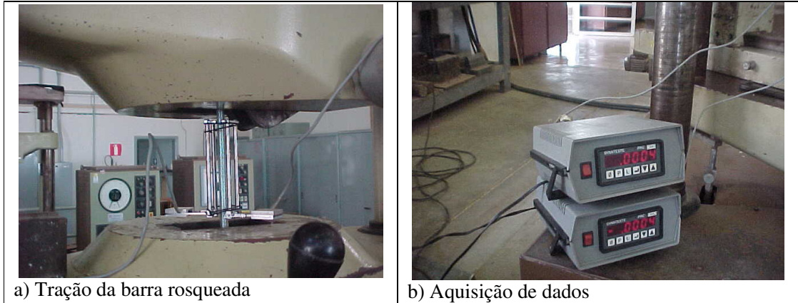
Figura 5.17 – Ensaio na barra rosqueada.
