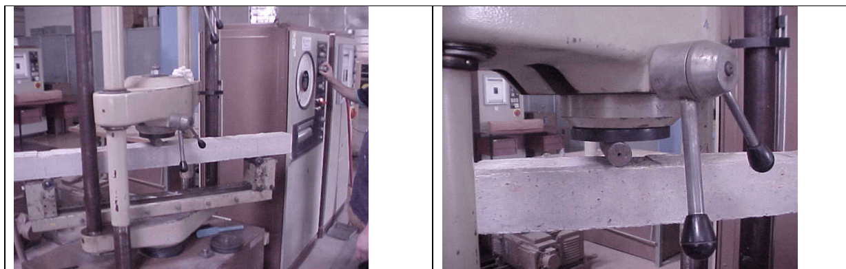
Figura 5.14 – Aplicação do carregamento central de curta duração no corpo-de-prova prismático.
