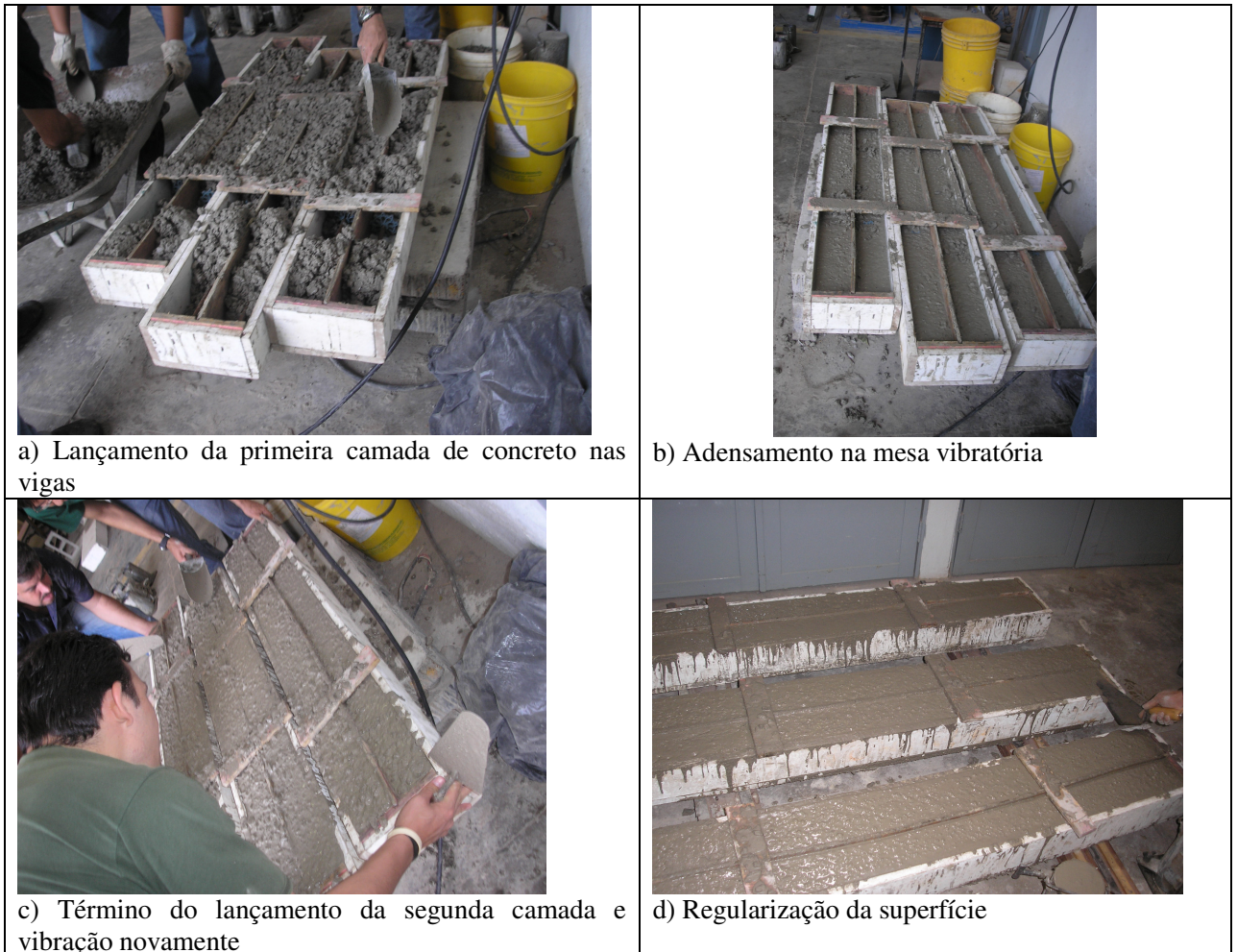
Figura 5.9 - Etapas da moldagem dos corpos-de-prova prismáticos.
