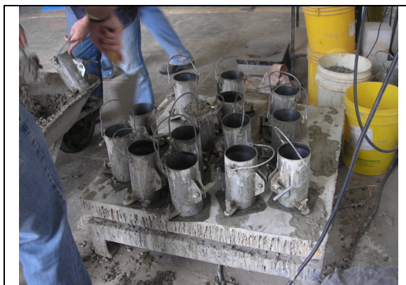
Figura 5.4 - Moldagem dos corpos-de-prova cilíndricos, utilizando mesa vibratória.
