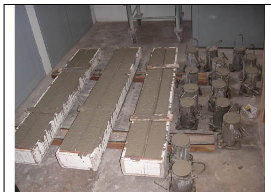
Figura 5.10 - Corpos-de-prova prontos para serem cobertos com lona plástica até a desforma.
