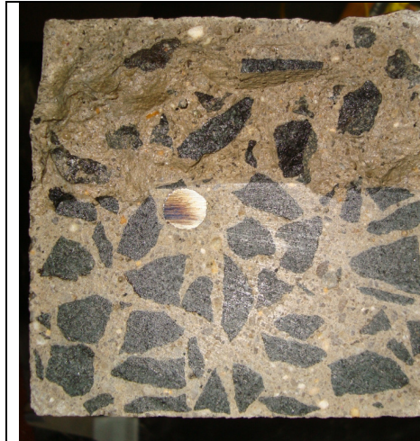
Figura 5.24 - Corpo-de-prova com solução de nitrato de prata, pronto para a leitura de profundidade de penetração de cloretos.
