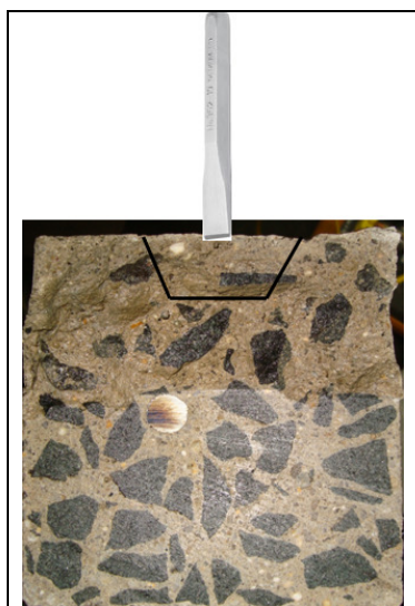
Figura 6.24 – Forma de retirada da amostra de concreto.
