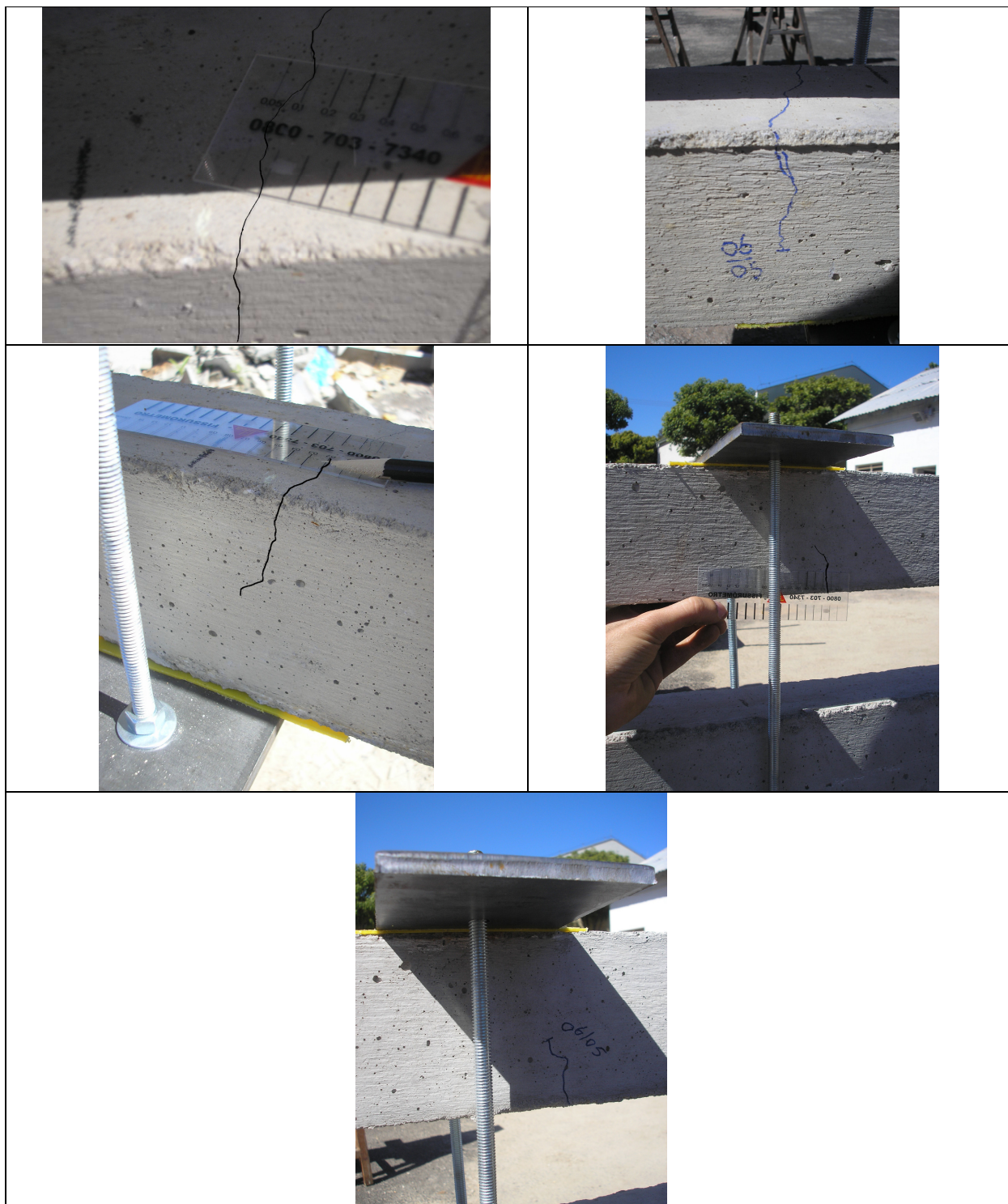
Figura 5.20 – Fissuras nos corpos-de-prova prismáticos após a aplicação do torque.
