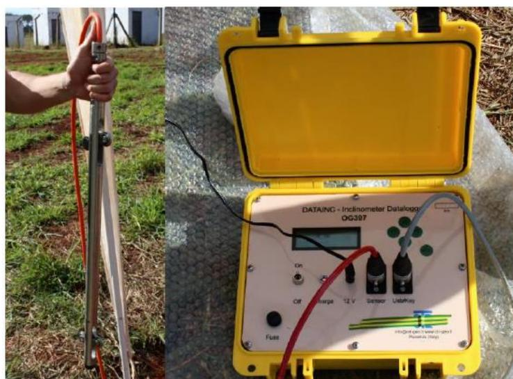
Figura 118 – Torpedo sensor e sistema de aquisição de dados do inclinômetro.
