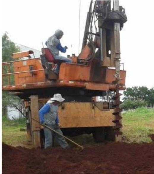
Figura 109 – Equipamento de perfuração trado helicoidal.
