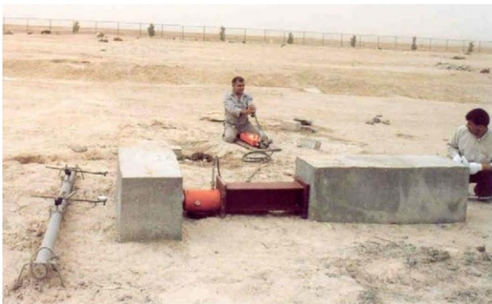
Figura 39 – Prova de carga horizontal - grupos G1 e G2. [Ismael \(2007\)](#)
