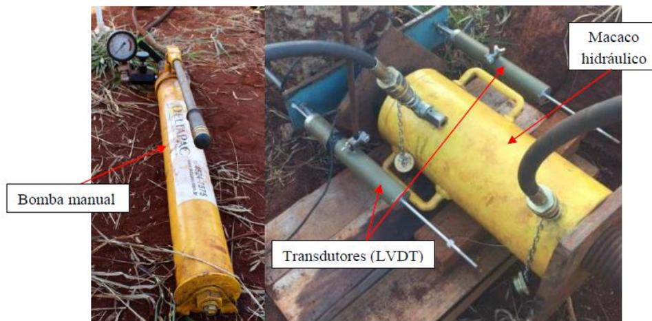
Figura 116 – Equipamentos para execução da prova de carga: Bomba Manual, Macaco hidráulico e Transdutores (LVDT).
