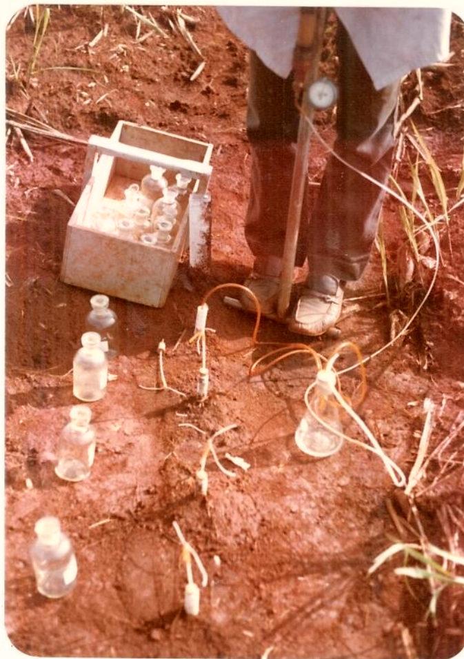
Figura 3.22 - Aspêcto da retirada da água da sonda, com o auxílio da bomba de vácuo.
