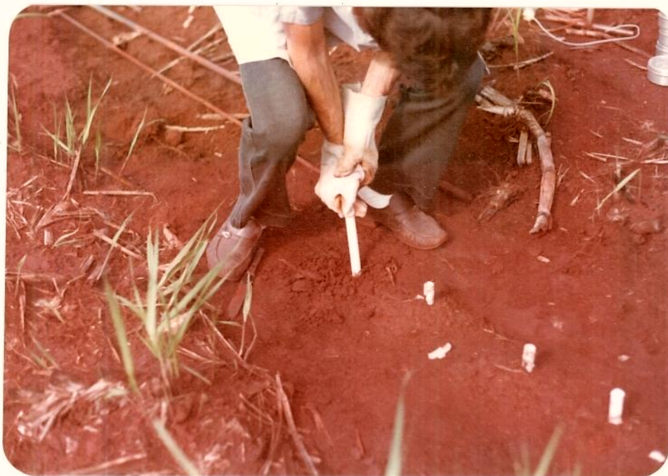
Figura 3.23 - Aspêcto de colocação da sonda no solo.
