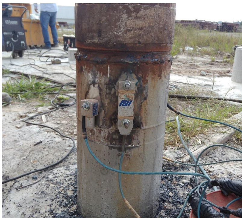
Figura 3.18 – Transdutor de força e acelerômetro instalado no topo da estaca.
