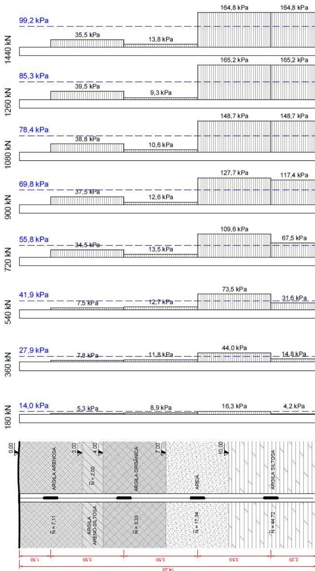
Figura 4.13 – Distribuição do atrito lateral ao longo do fuste.
