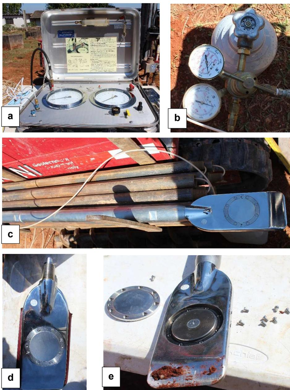
Figura 54. a) unidade de controle b) cilindro de gás c) hastes e cabo elétrico d-e) Lâmina dilatométrica.
