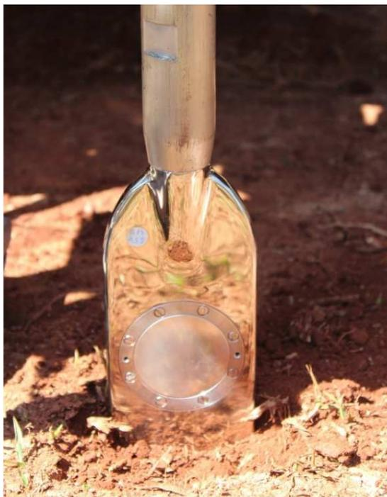
Figura 57. Lâmina apoiada no solo antes do início da cravação.
