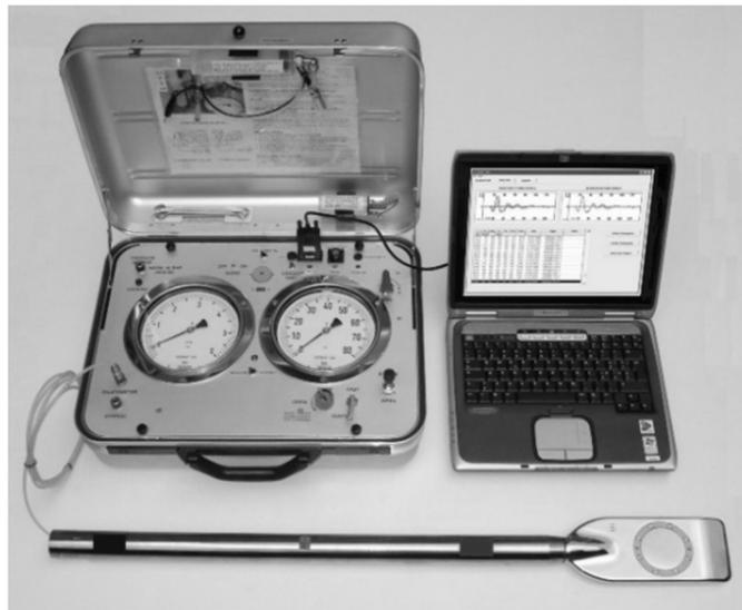
Figura 24. Dilatômetro sísmico (MARCHETTI, 2014).
