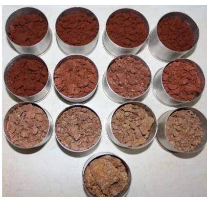
Figura 58. Amostras após secagem em estufa.
