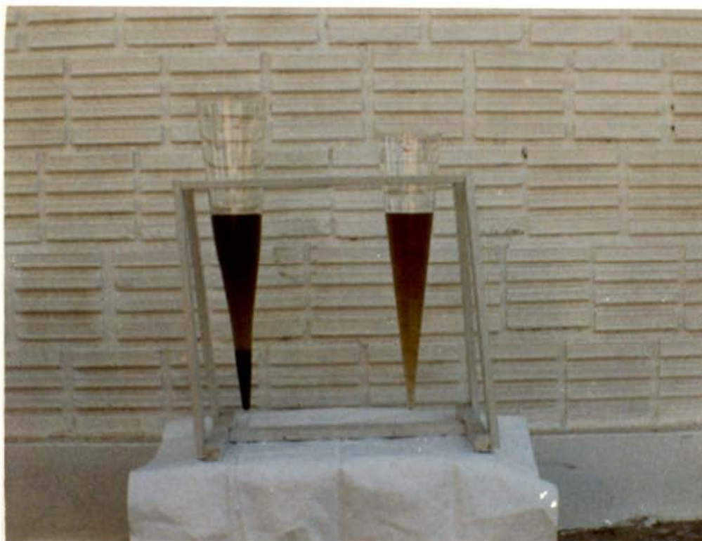
Figura 20. Resultado da análise de sólidos sedimentáveis para a rampa 2, no dia 26/07/89. A esquerda está o efluente bruto e a direita, o tratado.
