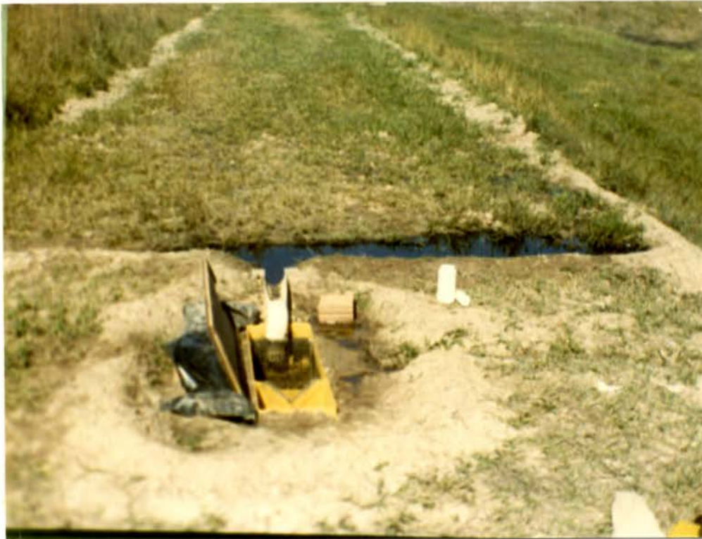
Figura 19. Visão geral da rampa 1, verificando-se a área (à esquerda) por onde não houve escoamento do efluente.
