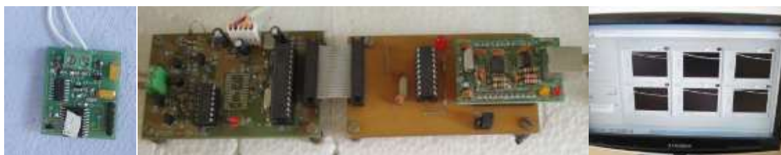
Figura 37 – Sensor de temperatura superficial interna e central de dados.
