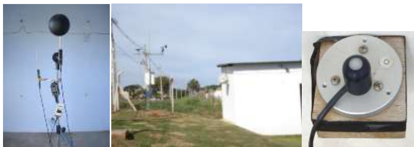
Figura 33 – Tripé com equipamentos no centro do protótipo, estação meteorológica, medição da radiação solar.
