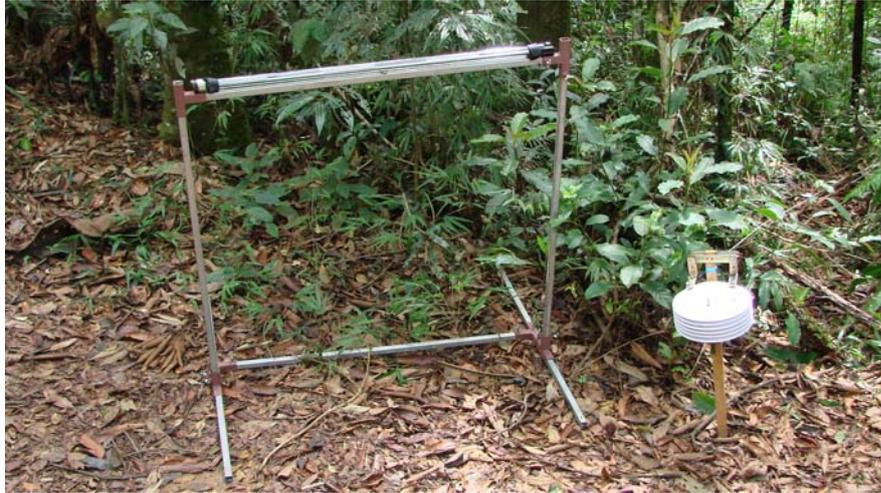
Figura 7: Disposição dos equipamentos de aferição de microclima no início de uma transecção.
