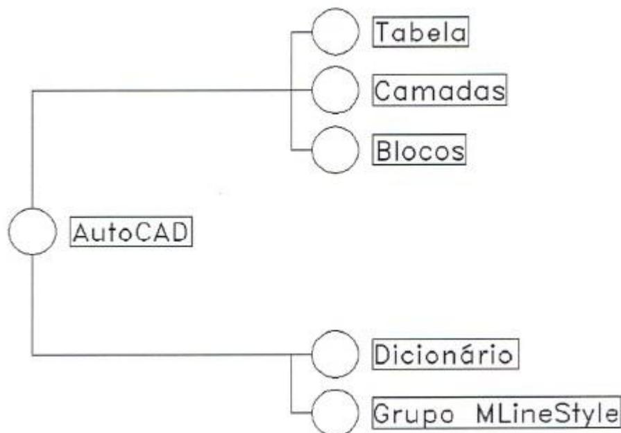
Figura 3.4: Objetos de um desenho no AutoCAD.
