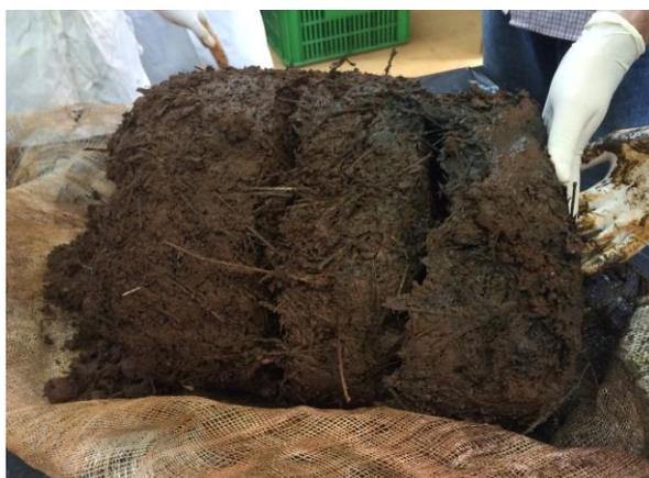
**Figura 48.** Fracionamento do substrato do vermifiltro alimentado com esgoto bruto em três camadas
