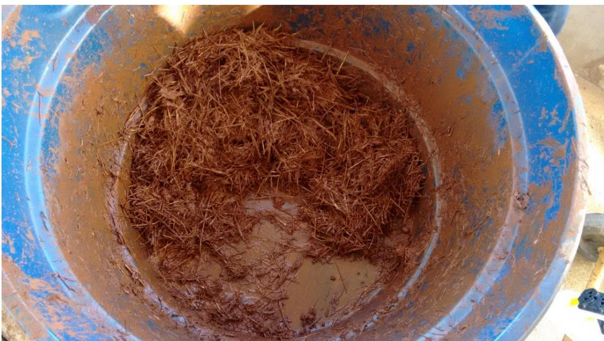
**Figura 18.** Vista do substrato utilizado nos vermifiltros logo após a mistura da braquiária seca com solo
