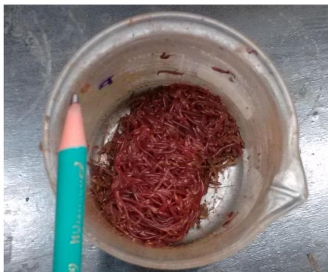
**Figura 50.** Minhocas filhotes e recém-nascidas removidas da porção inferior do substrato do vermifiltro alimentado com efluente do filtro anaeróbio
