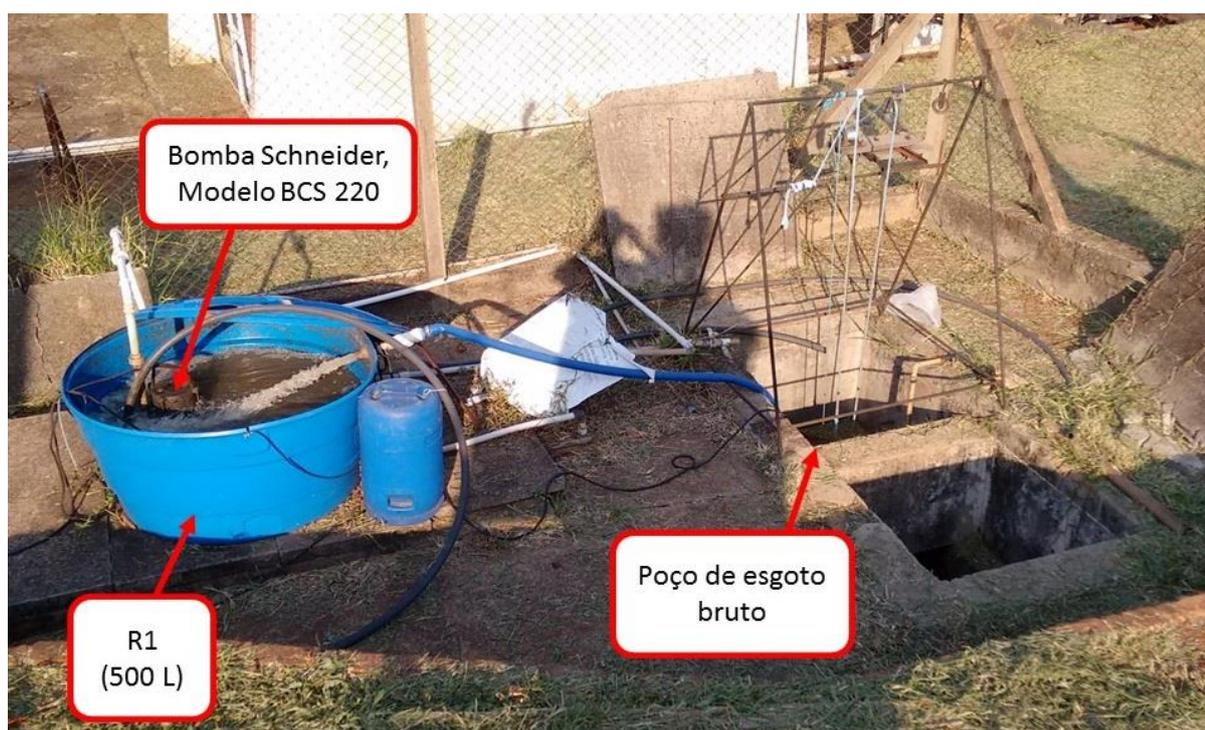
**Figura 4.** Vista do poço de coleta de esgoto bruto e do reservatório de esgoto R1.
