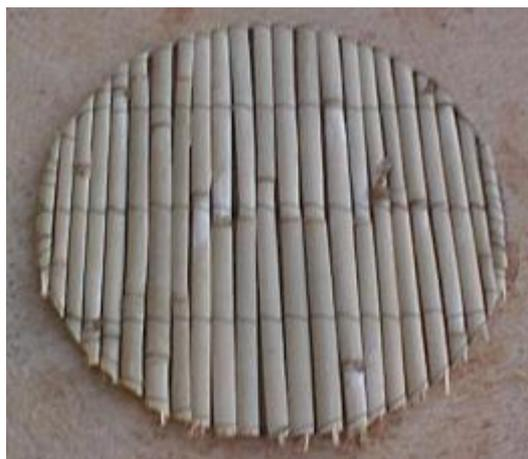
**Figura 13.** Grade de bambu acomodada ao filtro anaeróbio
