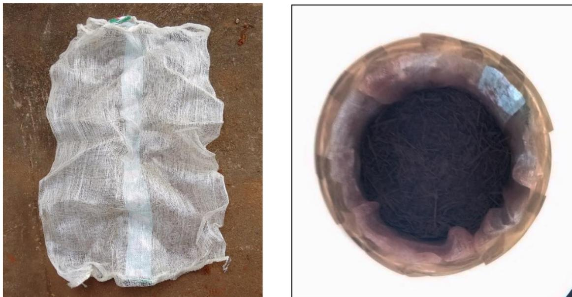
**Figura 19.** Vista do tecido “Raschel” e do topo do vermifiltro após a acomodação do substrato envolto no tecido
