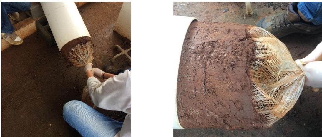
**Figura 42.** Vistas do substrato da camada superior ao ser retirado do vermifiltro
