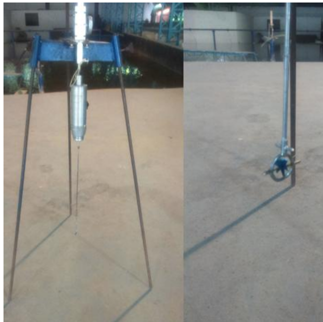
Foto 4.8. Micromolinete preso ao tripé (esquerda) e detalhe da hélice (direita).
