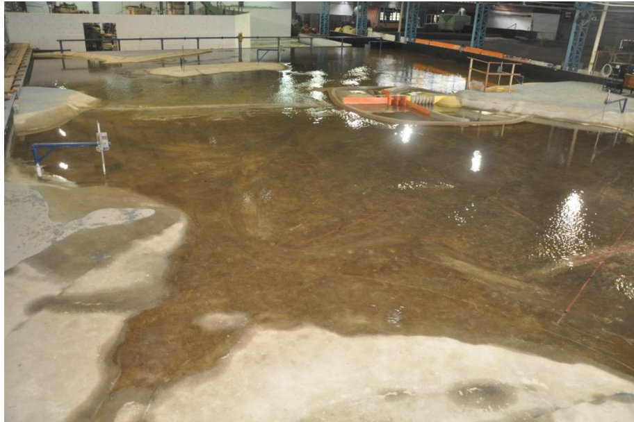
Foto 5.2. Condições gerais do escoamento no modelo físico – Q = 3618 \text{ m}^3/\text{s} .
