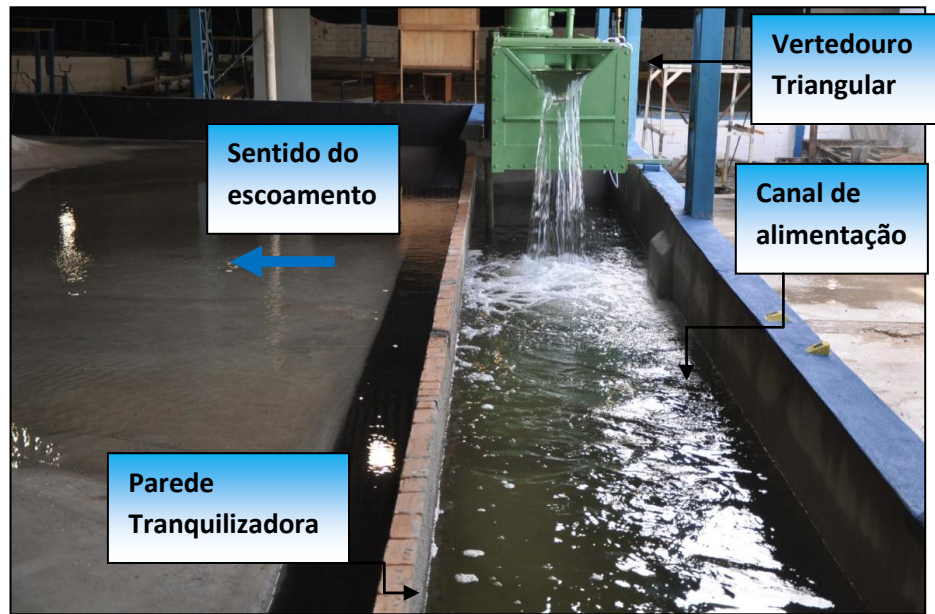
Foto 4.4. Vertedouro triangular, canal de alimentação e parede tranquilizadora.
