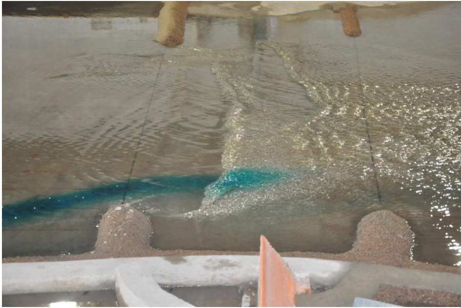
Foto 5.3. Condição do escoamento na região da ensecadeira para o avanço 1 – Q = 1874 \text{ m}^3/\text{s} .
