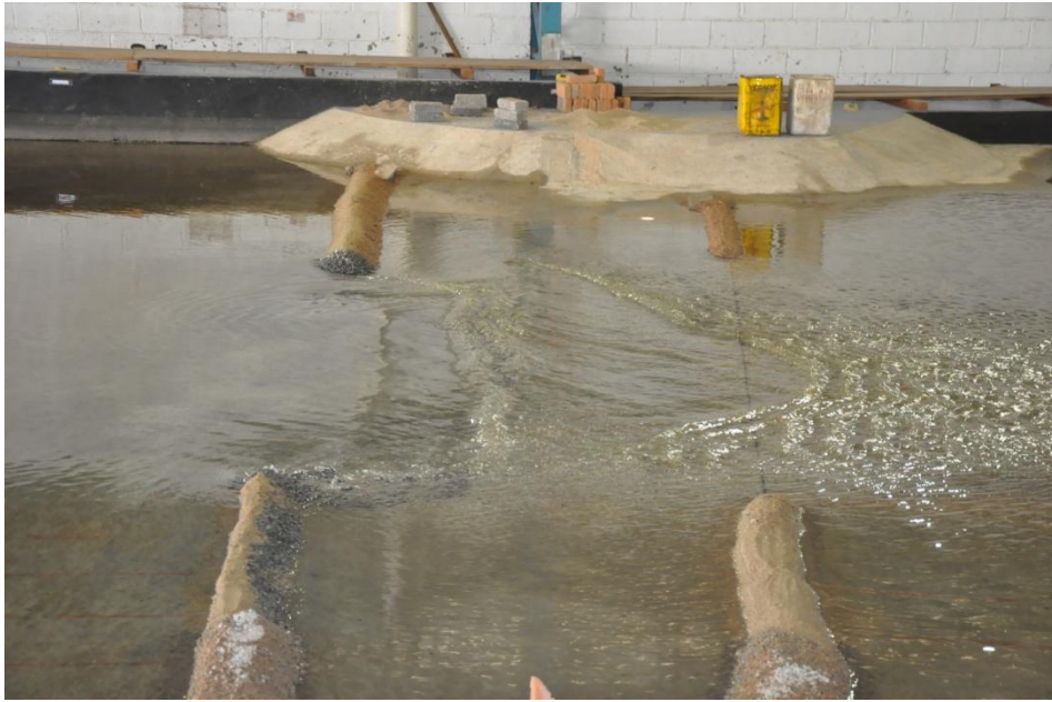
Foto 5.4. Condição do escoamento na região da enseadeira para o avanço 2 – Q = 1874 \text{ m}^3/\text{s} .
