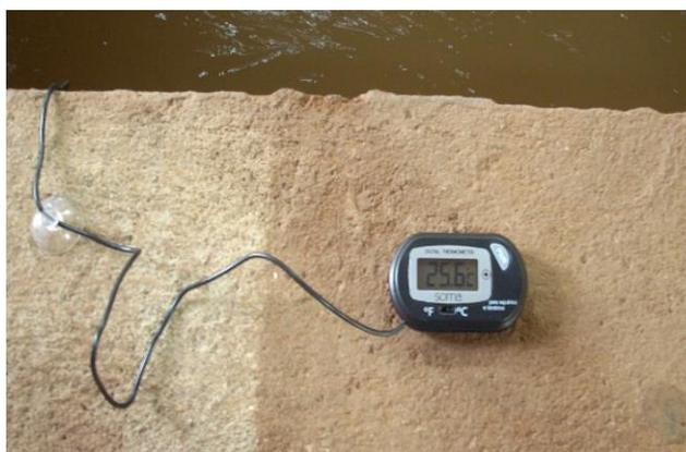
Figura 4.21: Termômetro digital no tanque superior
