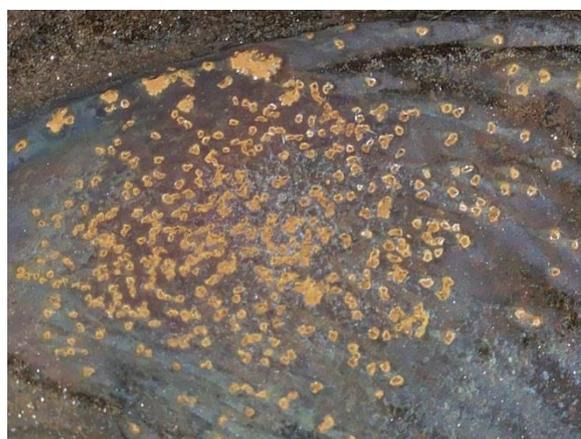
Figura 6.29 – Erosão no canal do rotor
