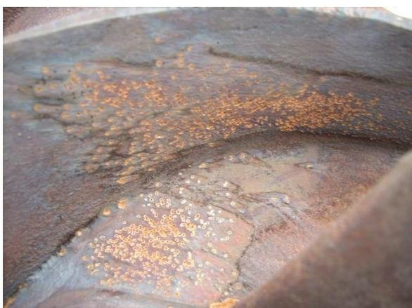
Figura 6.28 – Erosão no canal e aleta do rotor
