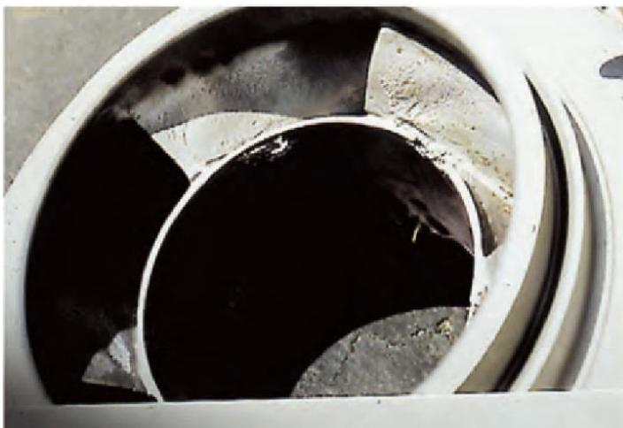
Figura 3.74 – Danos combinados de cavitação no rotor e na lingueta da voluta
