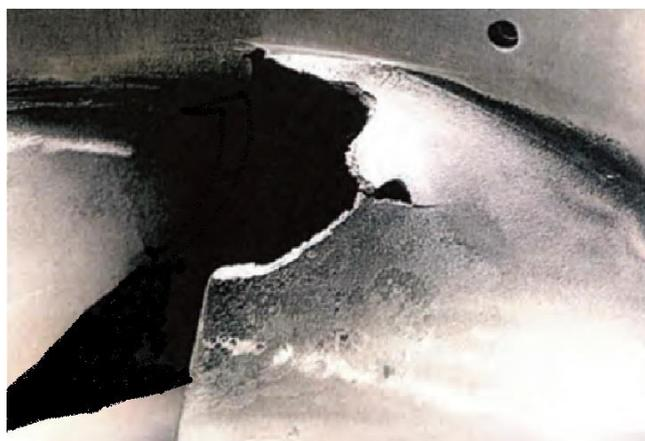
Figura 3.73 – Ataque na aleta por cavitação no lado da sucção
