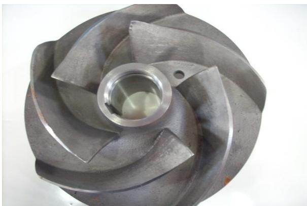
Figura 6.26 – Rotor de ferro fundido nodular antes do ensaio
