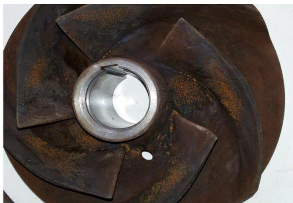
Figura 6.27 – Rotor de ferro fundido nodular após 300 h de ensaio
