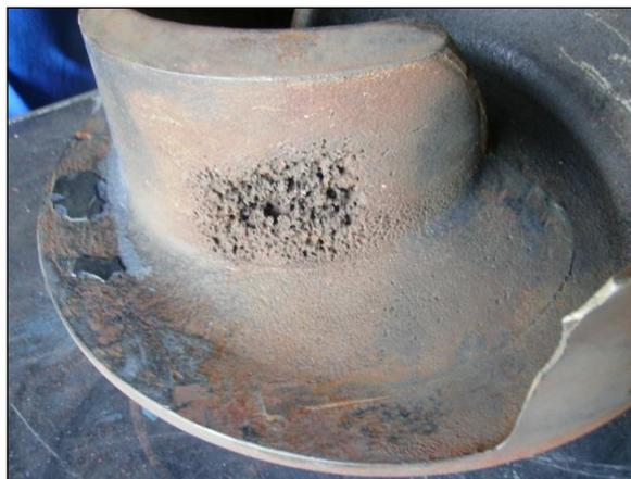
Figura 3.1 – Erosão do rotor por cavitação
