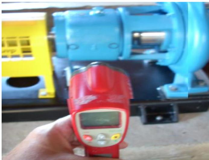
Figura 4.22: Medição com termômetro infravermelho
