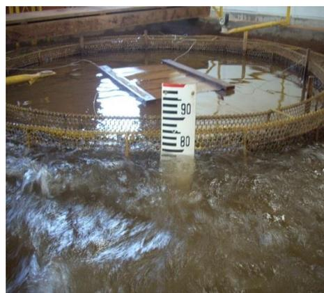
Figura 4.5: Tranquilizador, quebra vórtice e régua de nível
