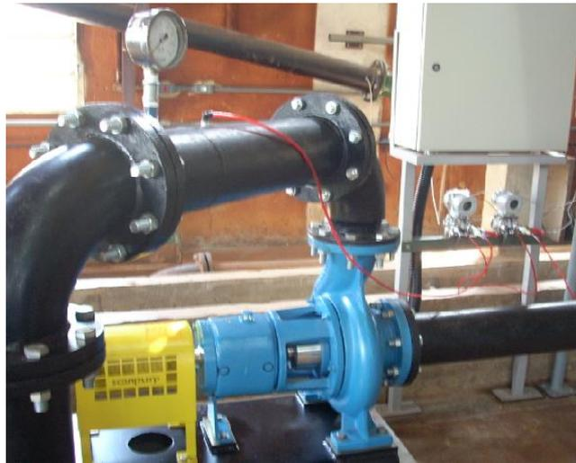
Figura 4.9 - Tubulação de recalque a jusante da bomba
