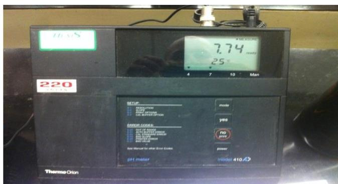
Figura 6.2: Medição do pH da água
