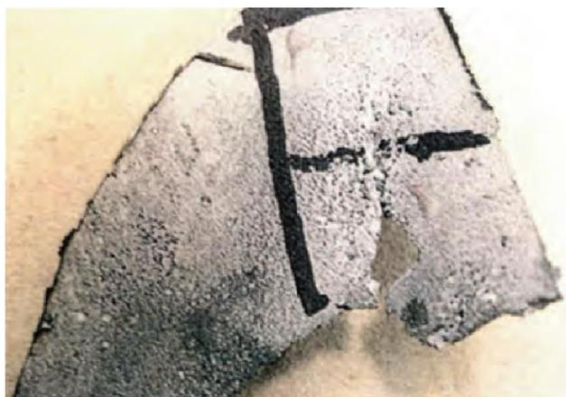
Figura 3.72 – Ataque na aleta por cavitação tipo vortex
