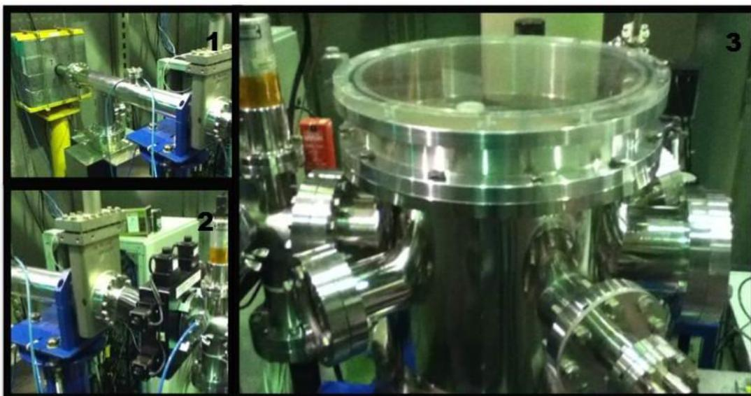
**Figura 4.3.** Linha de Fluorescência de Raios X (1- início da linha; 2- continuação da linha; 3- final da linha com câmara e suporte das amostras).
