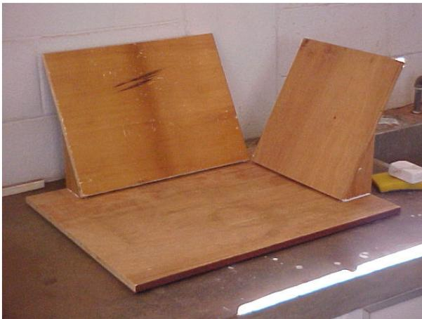
**FIGURA 11** Fixação das aletas na base do concentrador solar
