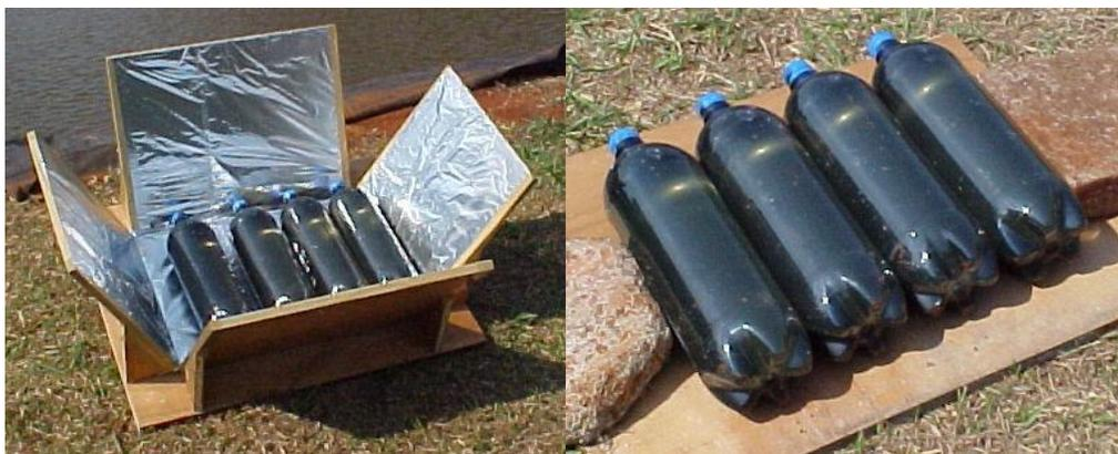
**Figura 14** Experimento em andamento: garrafas expostas ao sol com e sem a utilização do concentrados solar
