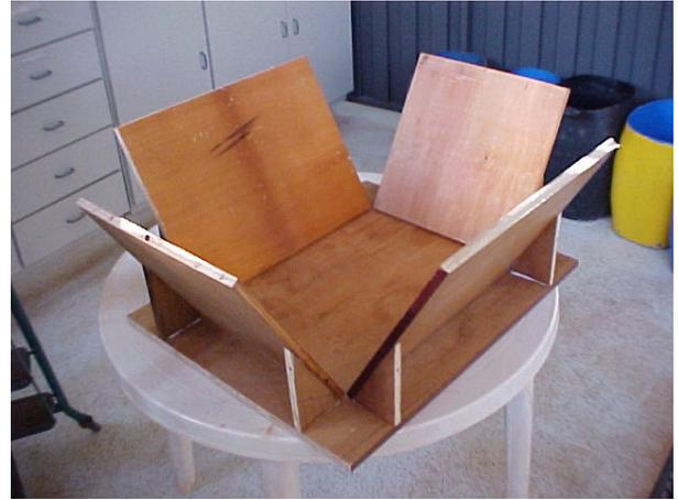
**FIGURA 12** Concentrador solar montado sem o revestimento de papel alumínio
