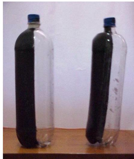
**Figura 24 Garrafas utilizadas no SODIS, à direita uma garrafas utilizada no concentrador solar com tempo de exposição de 6 horas que apresentou deformações**
