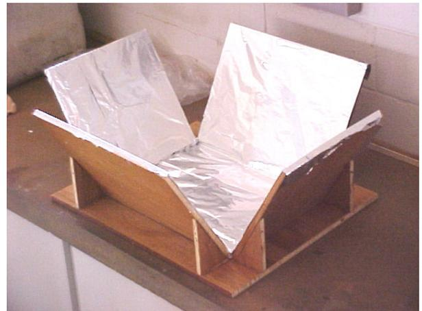
**FIGURA 13** Concentrador solar montado com o revestimento de papel alumínio
