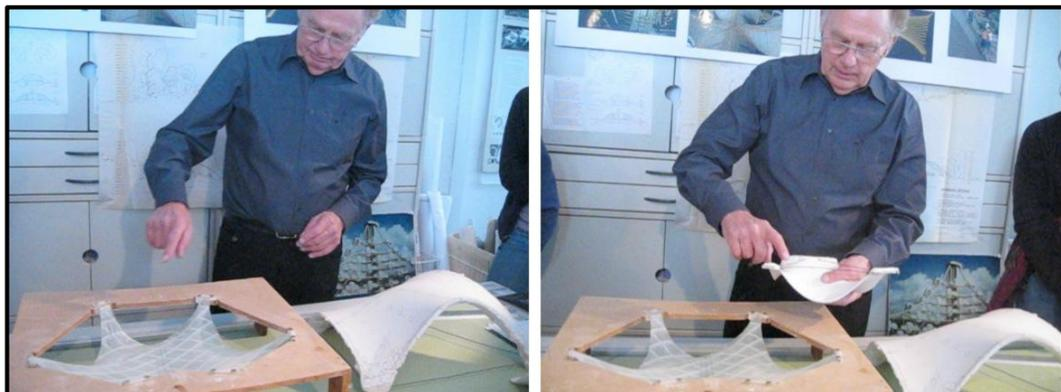
Figura 4. Método de Membranas Pênseis Invertidas utilizado por Isler. Fonte: <http://shells.princeton.edu/Grotz.html>. Acesso 04/2018.
