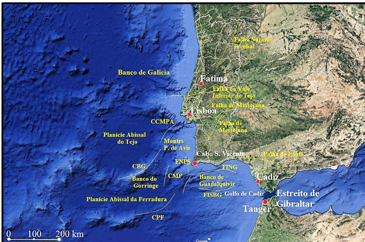
Figura 20. CBG – Carreamento do Banco de Gorringe; CCMPA – Carreamento da Montanha Príncipes de Avis; CPF – Carreamento da Planície da Ferradura; CMP – Carreamento do Marquês de Pombal; FNPS – Falha normal de Pereira de Sousa; FINBG e FISBG – Falha inversa Norte e Sul, respectivamente, do Banco de Guadalquivir; FIVIT – Falhas inversas do Vale Inferior do Tejo. Fonte: Adaptado de Carvalho *et al.* (2007).
