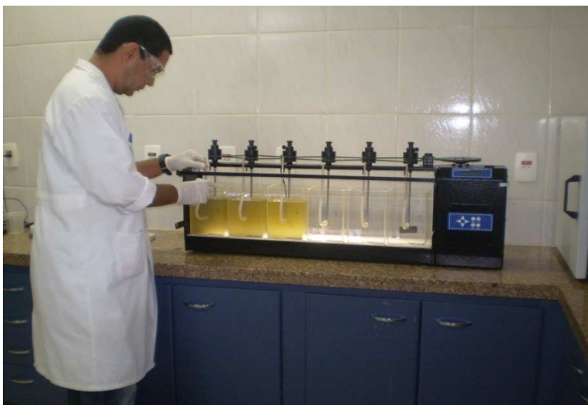
Figura 4.7 – Teste de cloração no efluente da lagoa facultativa da ETE de Itirapuã
