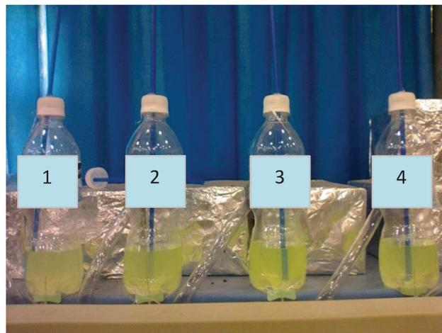
O sistema de Mariotte (Figura 21) foi feito em todos os reservatórios para que a carga hidráulica não se alterasse mantendo constante a vazão no filtro. O sistema foi
