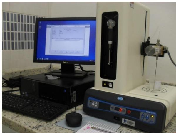
Figura 31: Sonda amostradora do contador de partículas.
