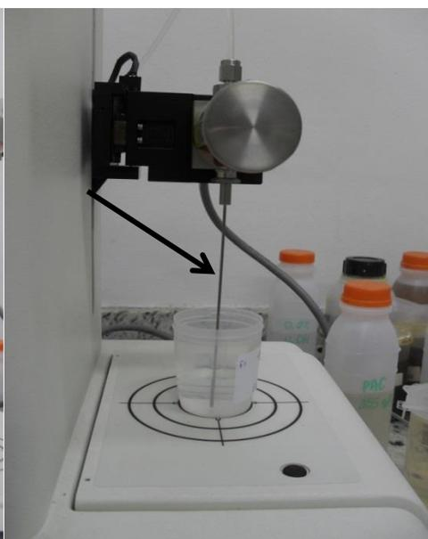
Também na ETA Guaraú foi medido o potencial zeta, no aparelho Zeta Sizer Nano ZS da Malvern, das amostras dos 1º VP e 10º VP das colunas 1, 5 e 9 (controle) e das colunas 2, 6 e 10 (teste) como descrito no Quadro 5, para comparação da evolução dos potenciais das carreiras de filtração com prata e sem prata.
