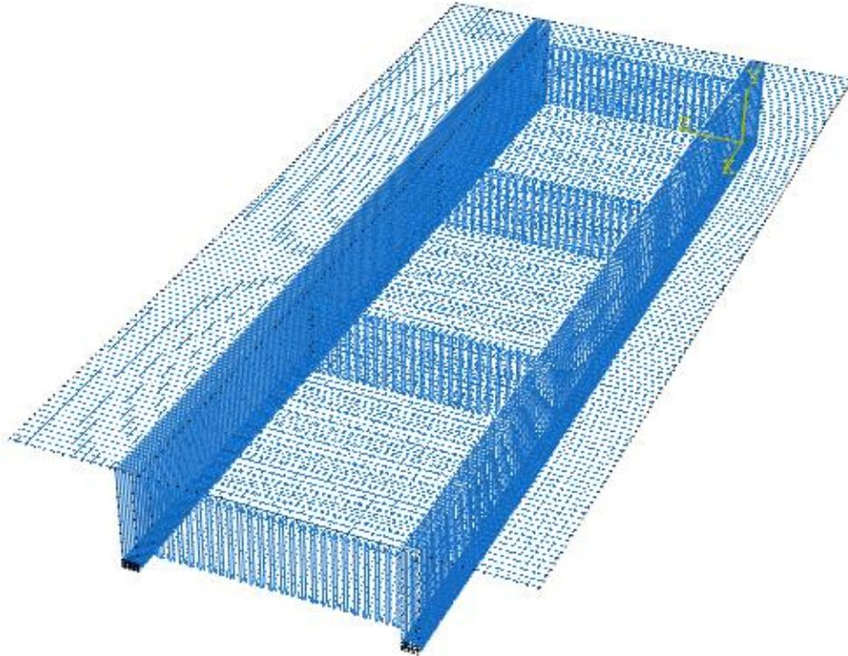
Figura 53 – Armação da ponte – Vista aproximada.
