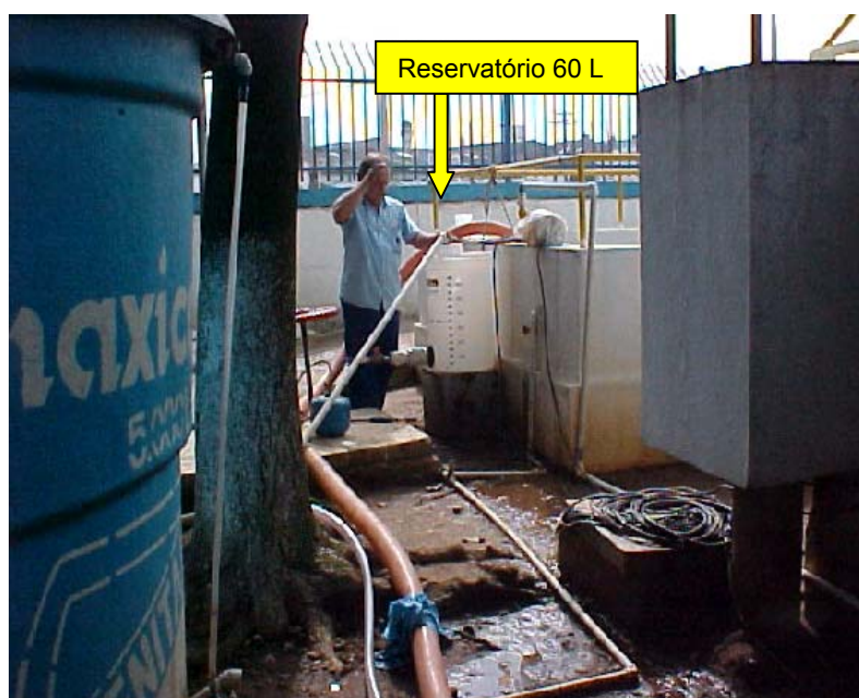
Figura 4.6: Vista do reservatório de 60 L que era cheio com o efluente.
