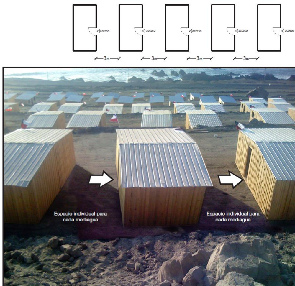
Figura 4.2.1.3 Exemplo de orientação apropriada dos acessos aos abrigos
