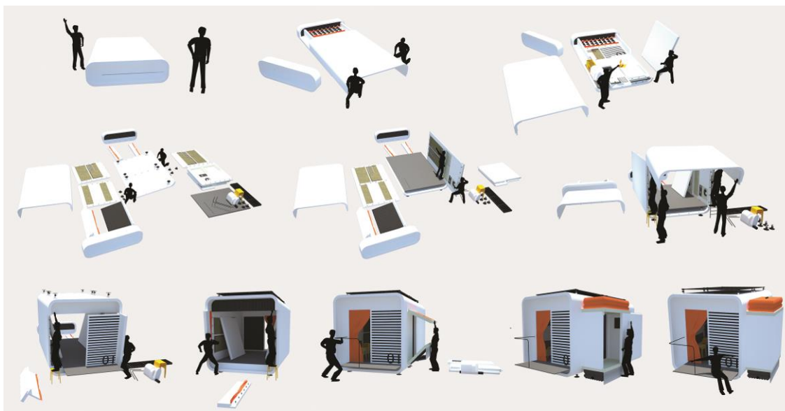
Figura 4.2.1.4 Montagem do abrigo emergencial e temporário desenvolvido pela autora
