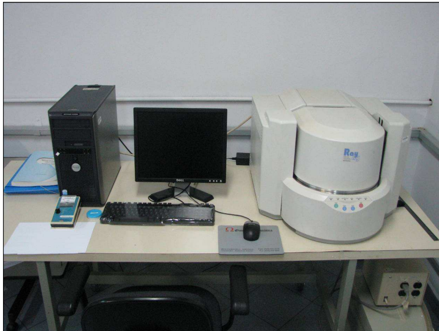
Figura 4.14 - Sistema utilizado para análise das amostras, contendo o espectrômetro acoplado a um computador.
