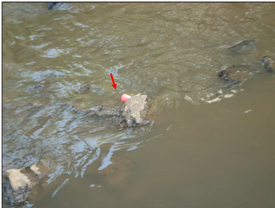
Figura 4.13 - Exemplo de imersão de dispositivos no leito do curso d'água. A seta indica a boia encostada em uma pedra no leito do rio, que foi colocada para facilitar a localização dos dispositivos posteriormente. Fotografada em 2/9/2012.
