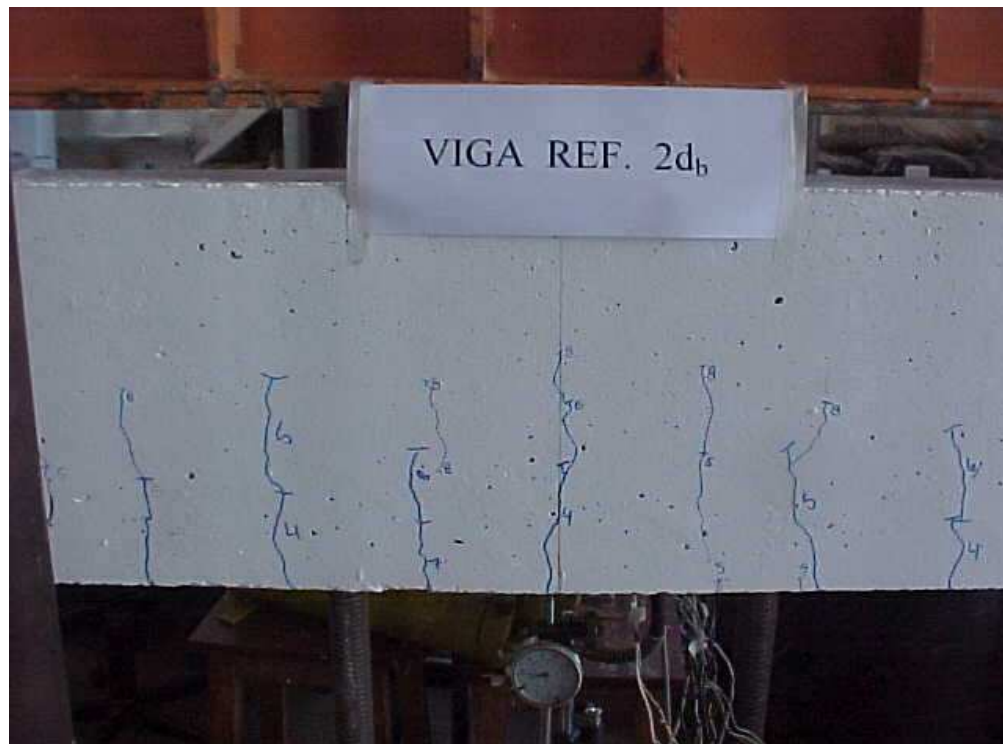
FIGURA A.6 – Vista lateral. Avanços das fissuras durante o carregamento
