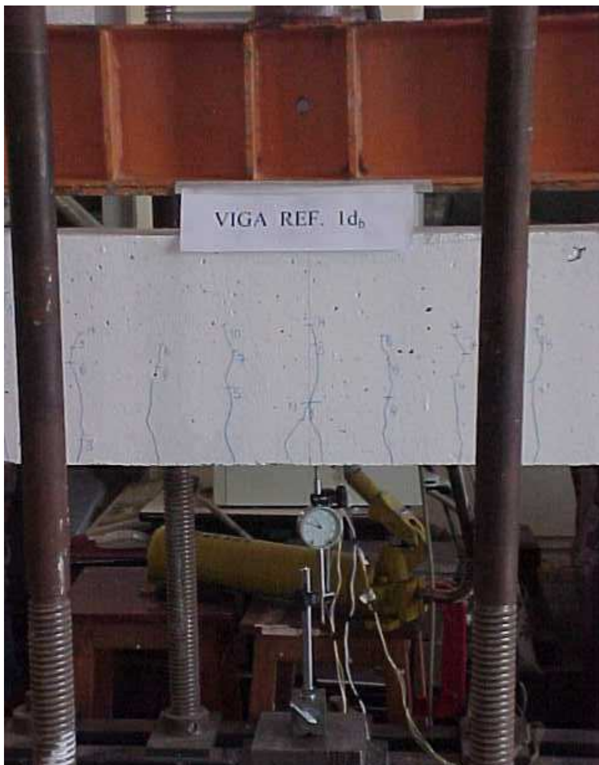
FIGURA 5.7 – Posicionamento do defletômetro no meio do vão
