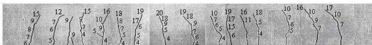
FIGURA 6.7 – Detalhe do panorama de fissuração da viga 7
