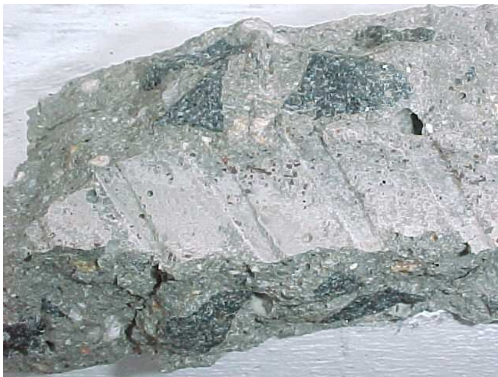
FIGURA A. 17– Detalhe das nervuras da armadura em uma amostra de concreto
