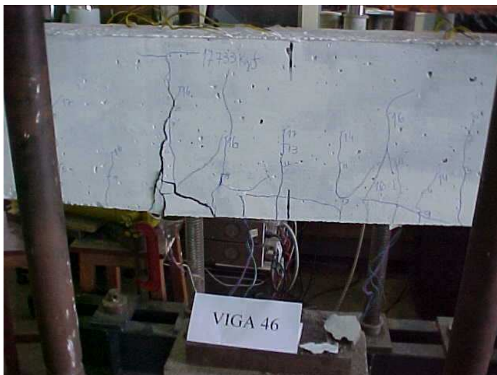
FIGURA A.8 – Detalhe das fissuras no instante da ruptura da viga
