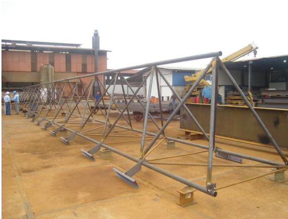
Figura 8 – Treliça com 30m de vão utilizando chapa de topo
