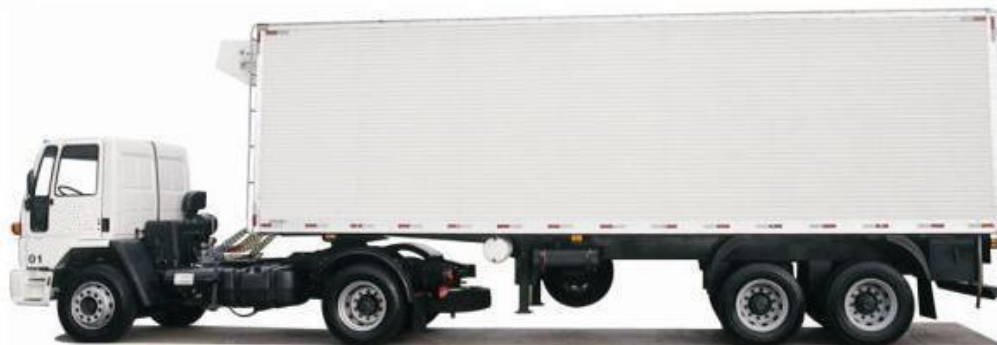
Figura 19: Exemplo de veículo semireboque com baú frigorífico e unidade de refrigeração
