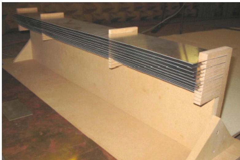
Figura 5.2 – Modelo de Barreira Acústica com Difrator Lamelar no Topo
