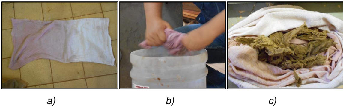
Figura 5.4 – a) Saco de algodão; b) Retirada do excesso de água com a torção manual do saco; c) Polpa sem o excesso de água
