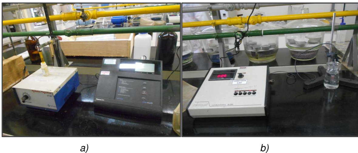
Figura 5.7 – Equipamentos utilizados para determinar pH e CE: a) pHmetro e eletrodo, b) condutivímetro e eletrodo
