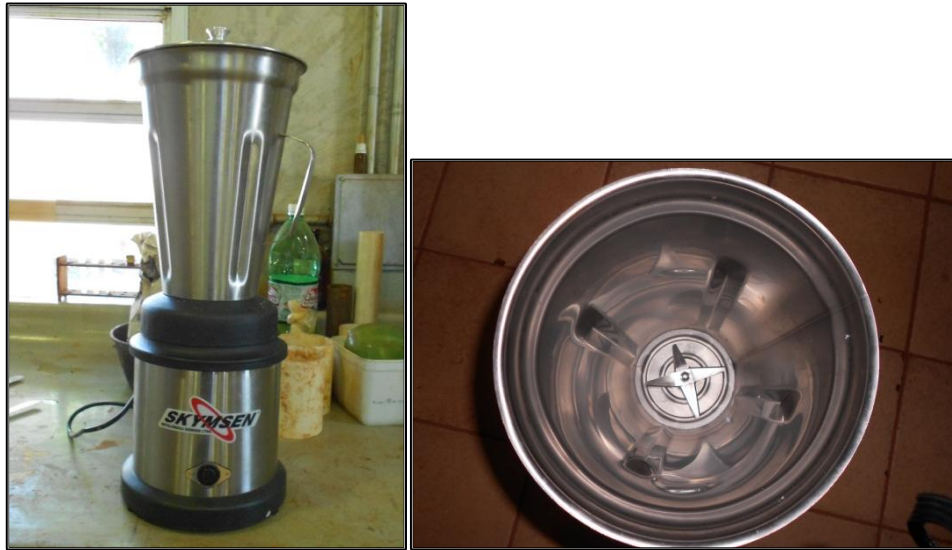
Figura 5.2 – Liquidificador industrial com cuba de 4 litros
