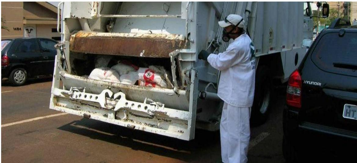
Nota-se, na Figura 5.28, que a altura de colocação de carga do veículo (compartimento de carga) é compatível com a estatura média dos trabalhadores. ABNT (1993d) estabelece que sempre que o carregamento do veículo de coleta for manual, a altura de carga deve ser inferior a 1,20m, sendo que todos os veículos de coleta de resíduo sólido de serviços de saúde devem ser inspecionados periodicamente, conforme NBR 14652: 2001 (ABNT, 2001).
