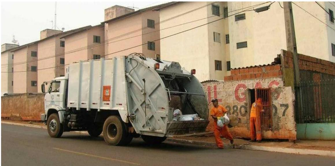
**Figura 5.20** Coleta domiciliar - Campo Grande/MS – detalhe da irregularidade em abrigo externo de resíduo – inexistência de degrau para facilitar a entrada do trabalhador
