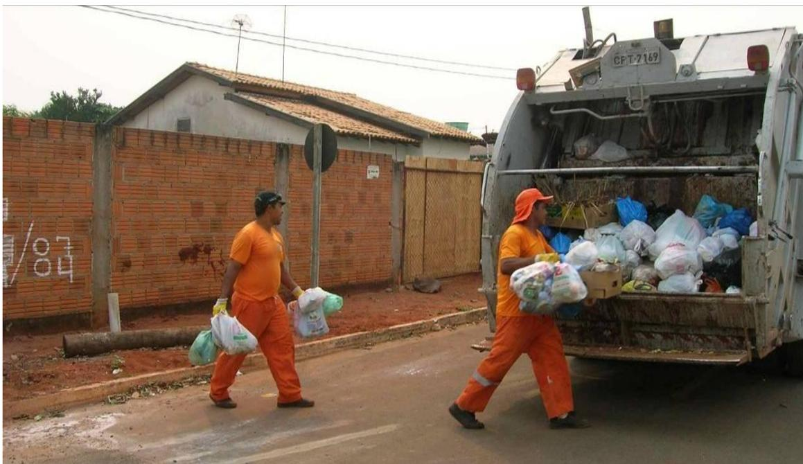
Na Figura 5.16 observa-se que o enchimento excessivo do compartimento de carga do equipamento compactador, por parte dos coletores de resíduo, obriga-os a executarem um procedimento arriscado (risco de acidentes graves) ao apoiarem o resíduo com as mãos, durante o acionamento do cilindro transportador.
