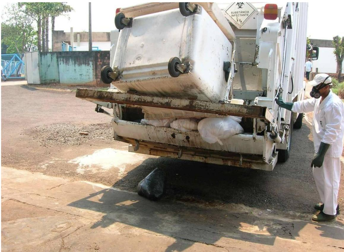
**Figura 5.32** Coleta de resíduo sólido de serviços de saúde - Campo Grande/MS - necessidade de avental impermeável, durante a coleta
