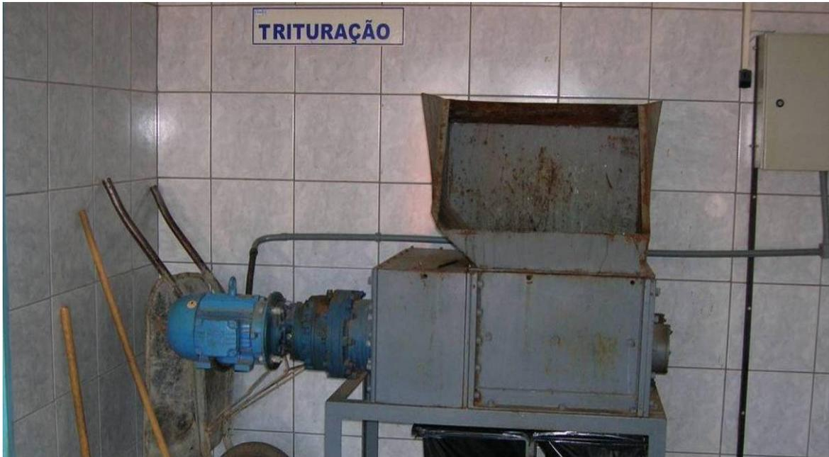
**Figura 5.49** Unidade de tratamento de resíduo sólido de serviços de saúde – Penápolis/SP – detalhe interno do triturador
