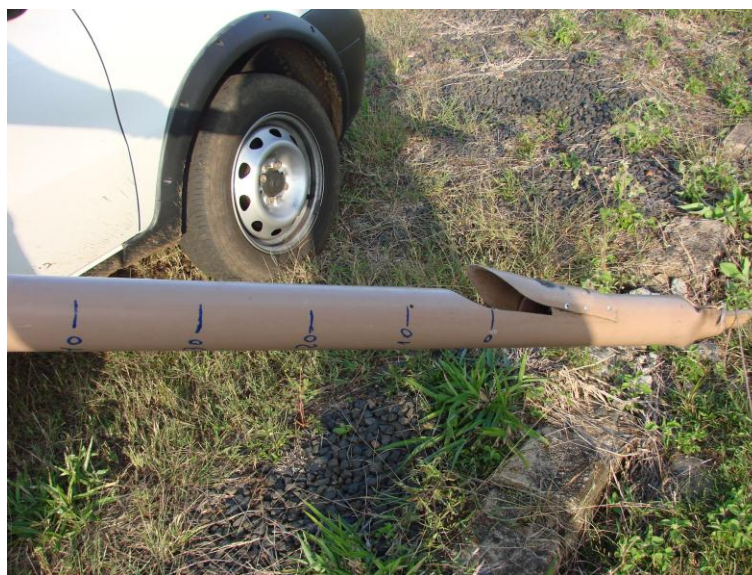
Figura 4.31 - Coletor para extrair lodo do interior dos bags
