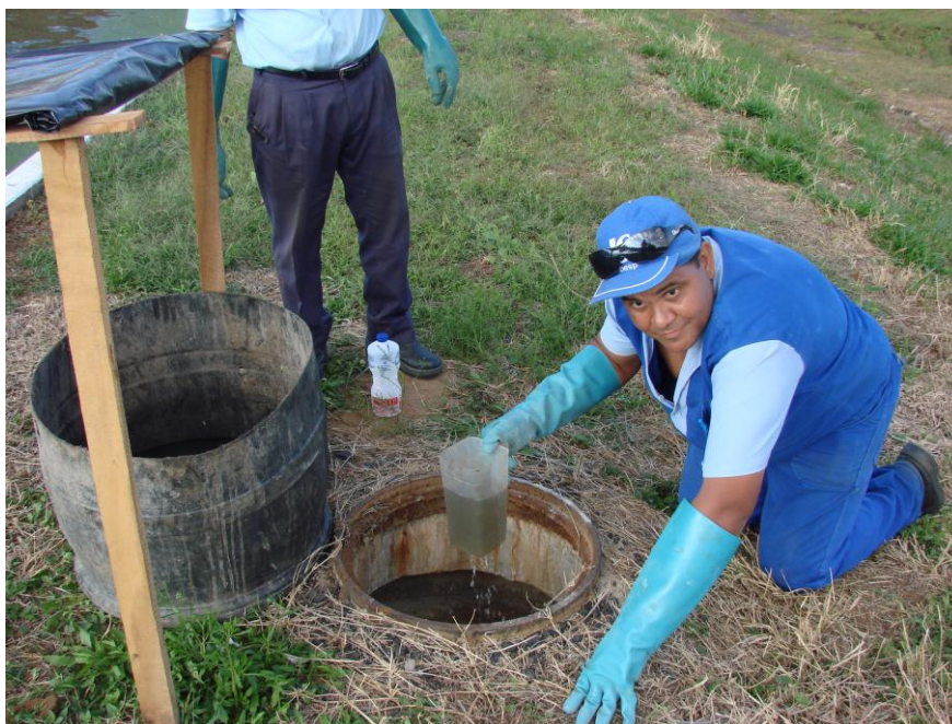
Figura 4.32 - Tambor e jarra para coleta de amostras da entrada e saída da lagoa
