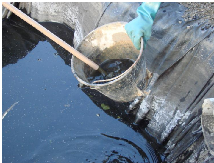
Figura 4.35 - Tubo de PVC para retirada do material percolado
