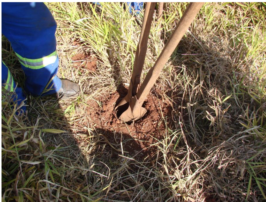
Figura 4.33 - Cavadeira para coleta de solo
