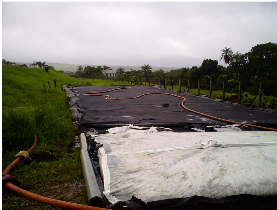
Figura 4.19 - Foto dos bags : Alternativo (branco) no início de seu enchimento e Importado (preto) ainda vazio (16/12/2008)
