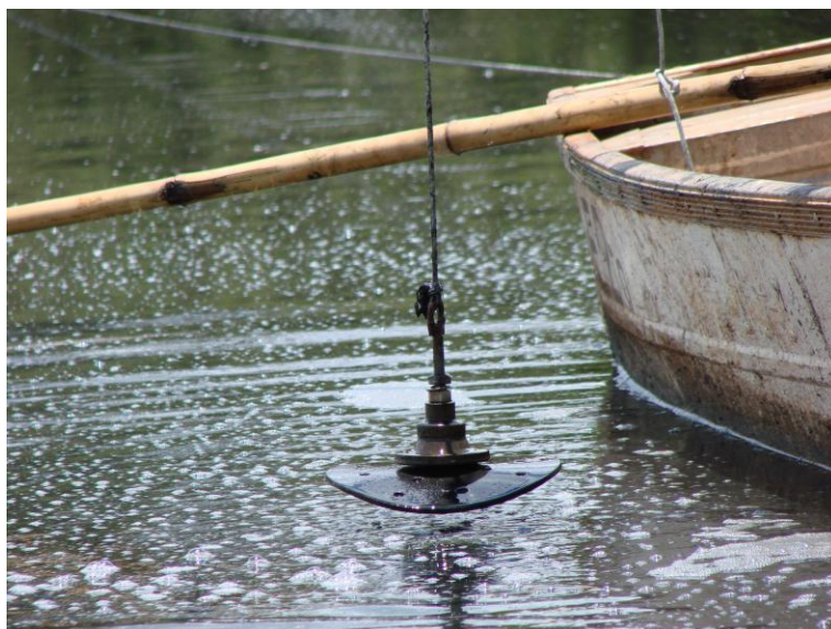
Figura 4.12 - Disco para a realização das medidas da lâmina d'água da lagoa anaeróbia da ETE Pedregulho
