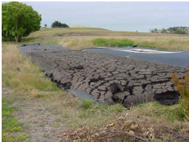
Figura 3.10 - Bag em Korumburra (Austrália) aprox. duas semanas após abertura
