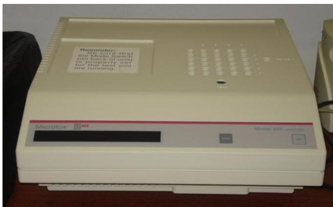
**Figura 4.5-** Equipamento utilizado para a realização do ensaio de toxicidade aguda em *V. fischeri*: Analisador de toxicidade Microtox™500 Analyser. Fonte: TORRES, D.L.F.F.
