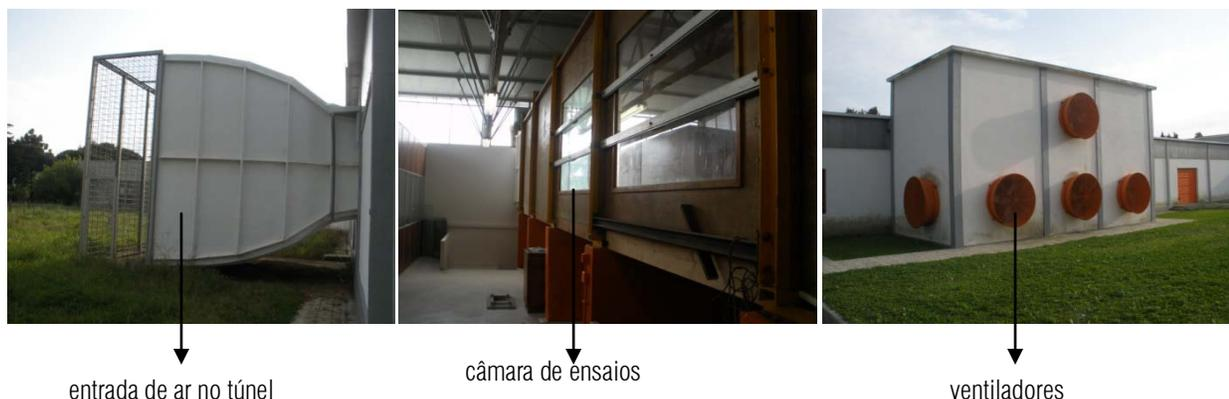
Figura 4.3: Túnel de vento de seção aberta do LNEC
