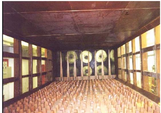
**Figura 4.2:** Túnel de vento usado no experimento (WONG e HERYANTO, 2004)
