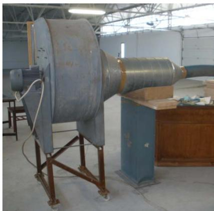
**Figura 4.15:** Ventilador conectado ao pleno
