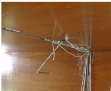
**Figura 4.8:** Tubo de Pitot no interior do túnel
