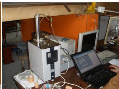
**Figura 4.9:** Micromanômetro e sistema de aquisição de dados
