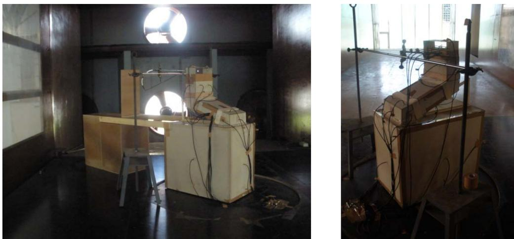
**Figura 4.12:** Ensaios para determinação dos coeficientes de pressão – com barreira e sem barreira
