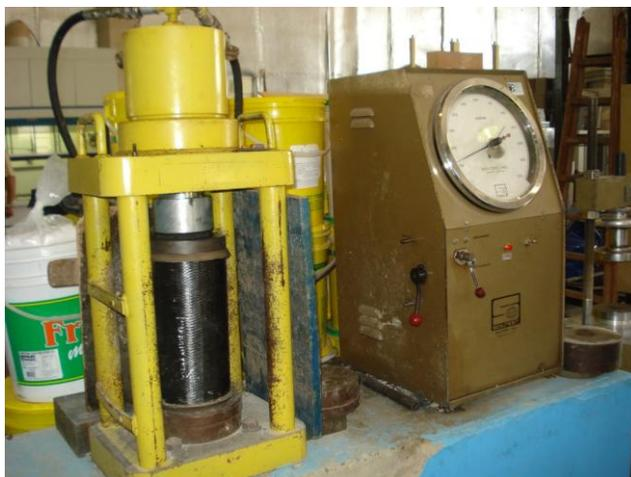
**Figura 9.12** – Prensa utilizada nos ensaios de compressão
