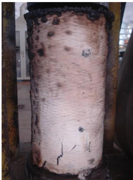
**Figura 11.6** – Corpo de prova aquecido a 500 °C (protegido com tinta)
