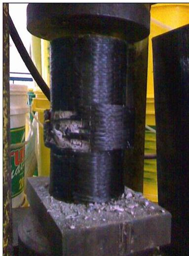
**Figura 11.2** – Ensaio à compressão de corpo de prova de concreto reforçado com fibra de carbono
