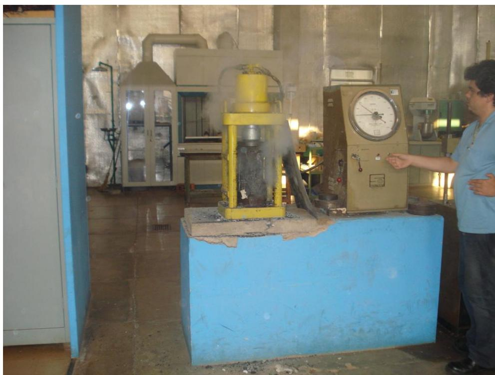
**Figura 11.12** – Corpo de prova aquecido a 800 °C – fumaça gerada no rompimento
