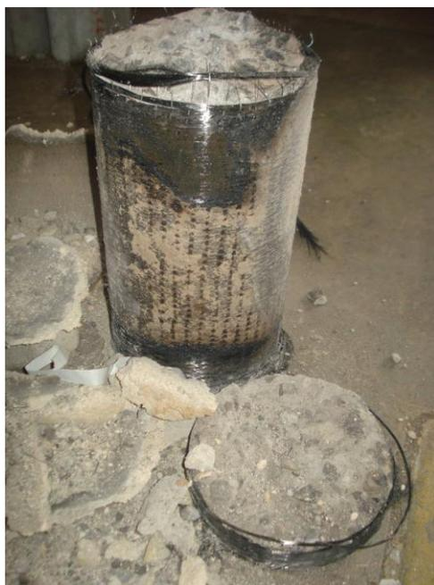
**Figura 11.27** – Corpo de prova dividido em duas partes devido ao *Spalling*
