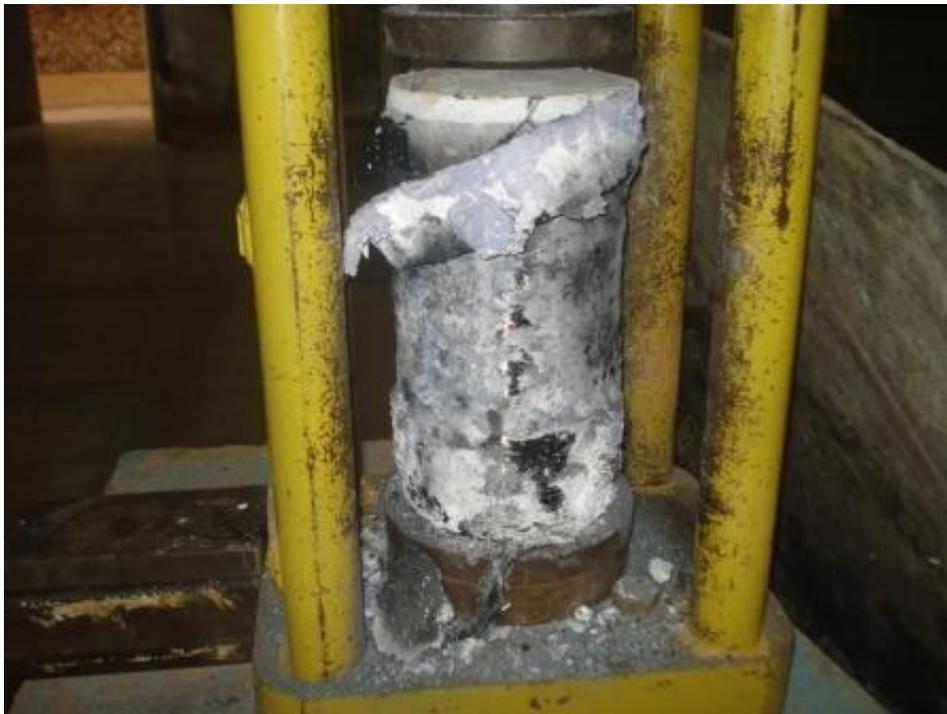
**Figura 11.14** – Corpo de prova aquecido a 1050 °C (detalhe da delaminação da tinta)
