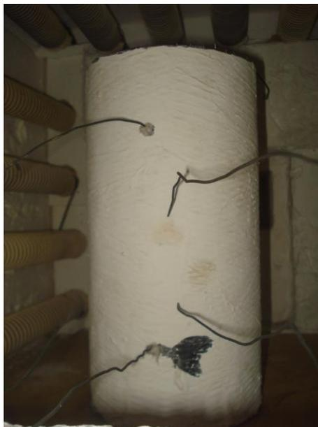
**Figura 9.5** – Corpos de prova protegido com tinta intumescente
