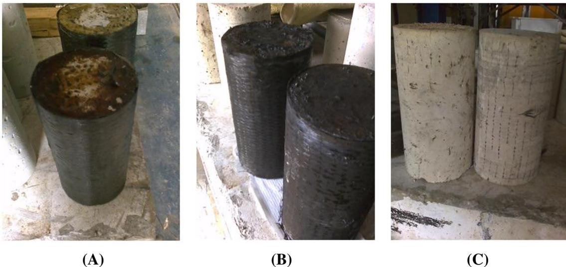
**Figura 11.1** – Aspecto dos corpos de provas expostos ao incêndio – padrão – (A) amostras expostas a 400 °C, (B) amostras expostas a 700 °C e (C) amostras expostas a 1050 °C
