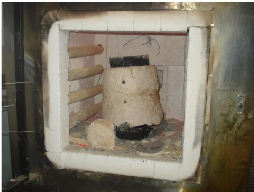
**Figura 11.26** – *Spalling* no corpo de prova aquecido a 1150 °C
