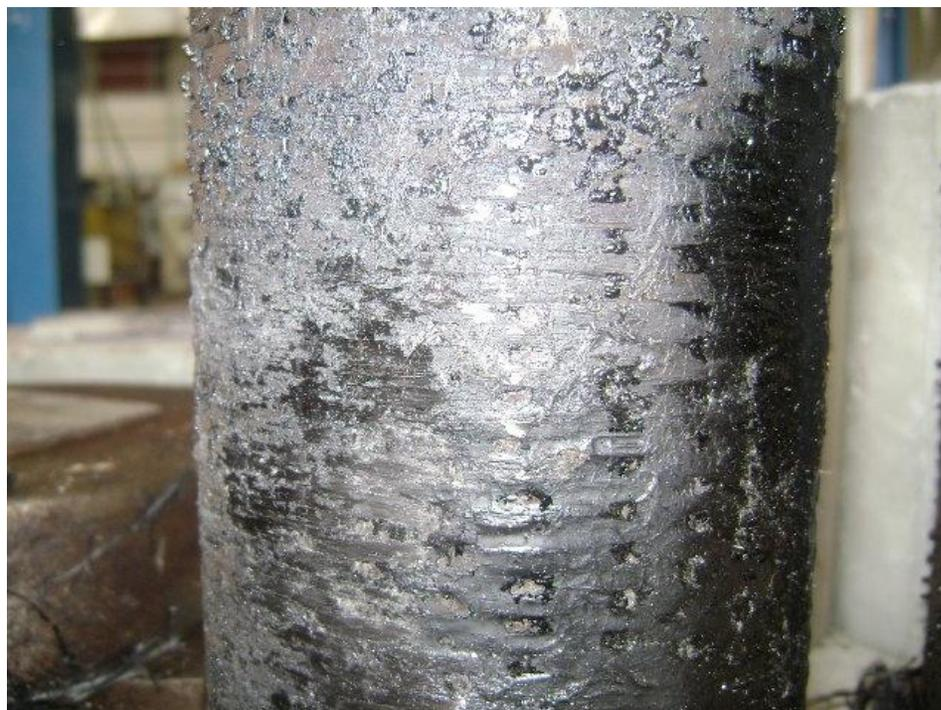
**Figura 11.4** – Superfície do corpo de prova exposto ao incêndio – padrão
