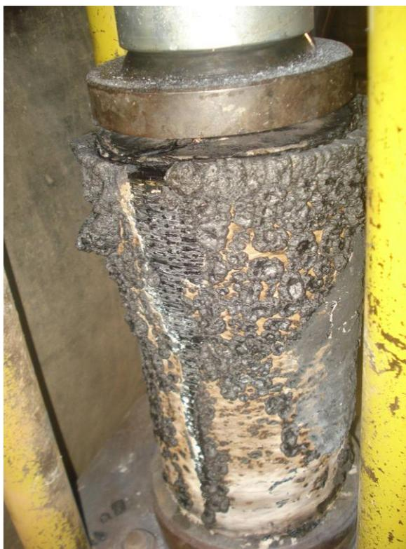
**Figura 11.8** – Corpo de prova aquecido a 600 °C, protegido com tinta no momento da ruptura
