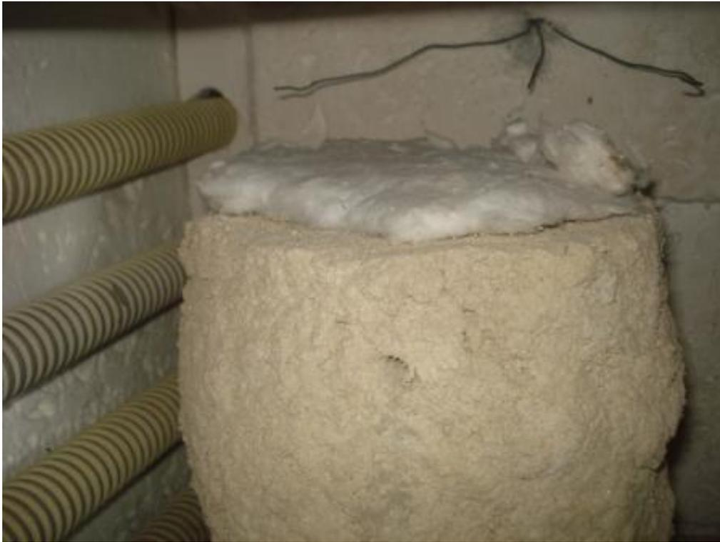
**Figura 9.13** – Detalhe da lã cerâmica na face superior do corpo de prova
