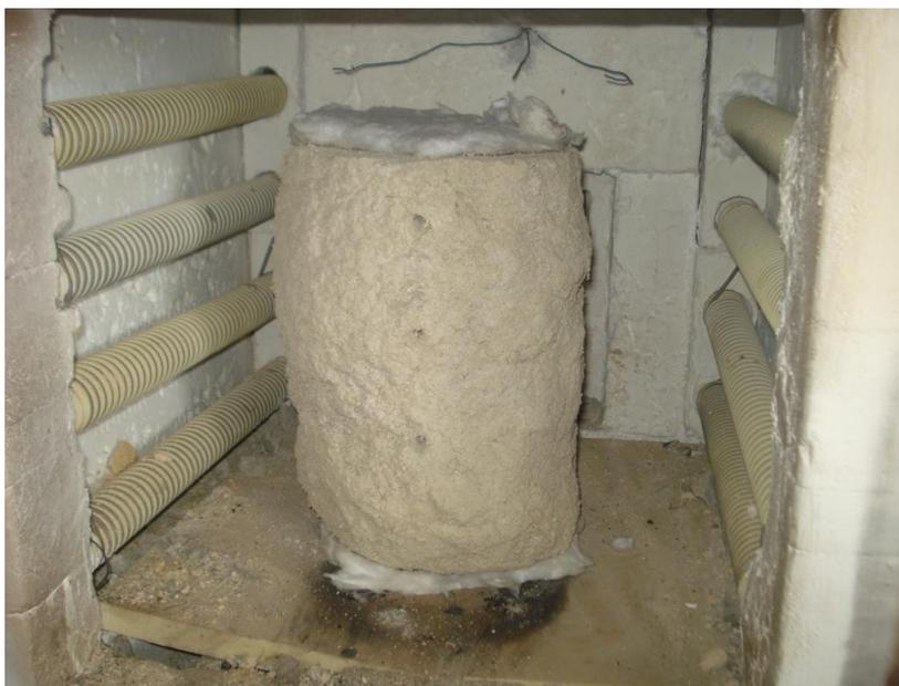
**Figura 9.6** – Corpos de prova protegido com argamassa projetada
