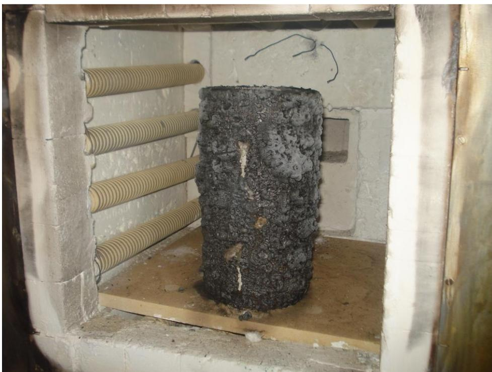
**Figura 11.10** – Corpo de prova aquecido a 800 °C (protegido com tinta)
