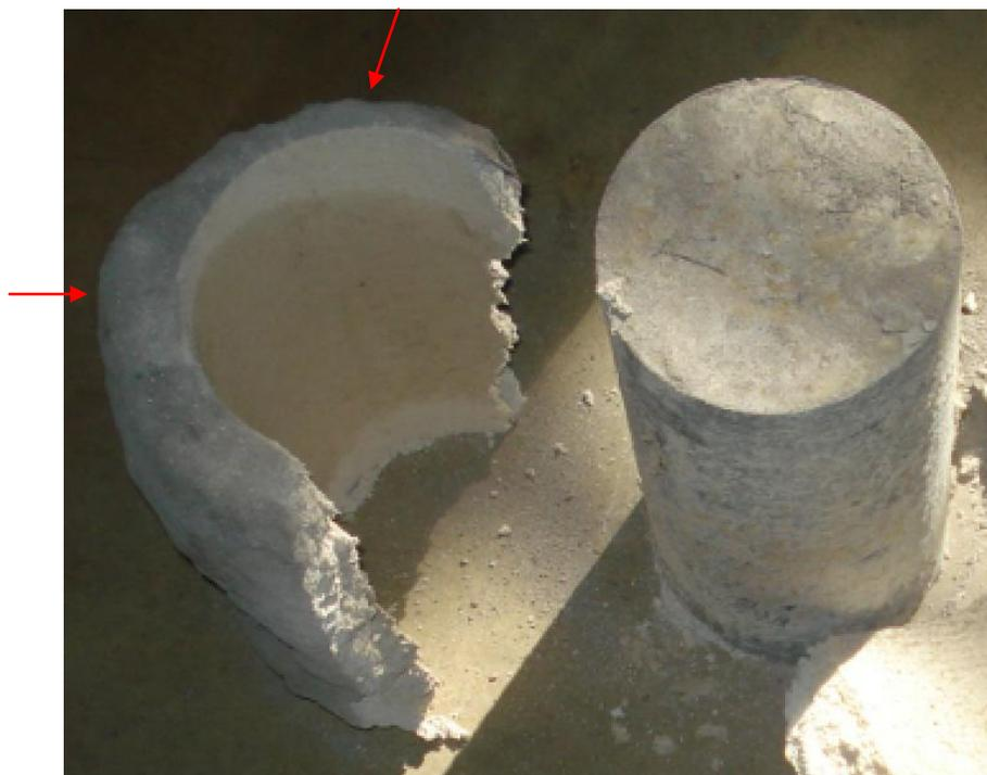
**Figura 11.31** – Detalhe da não uniformidade da camada de proteção
