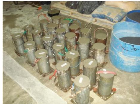
**Figura 9.1** – Moldagem dos corpos de prova de 15 cm de diâmetro
