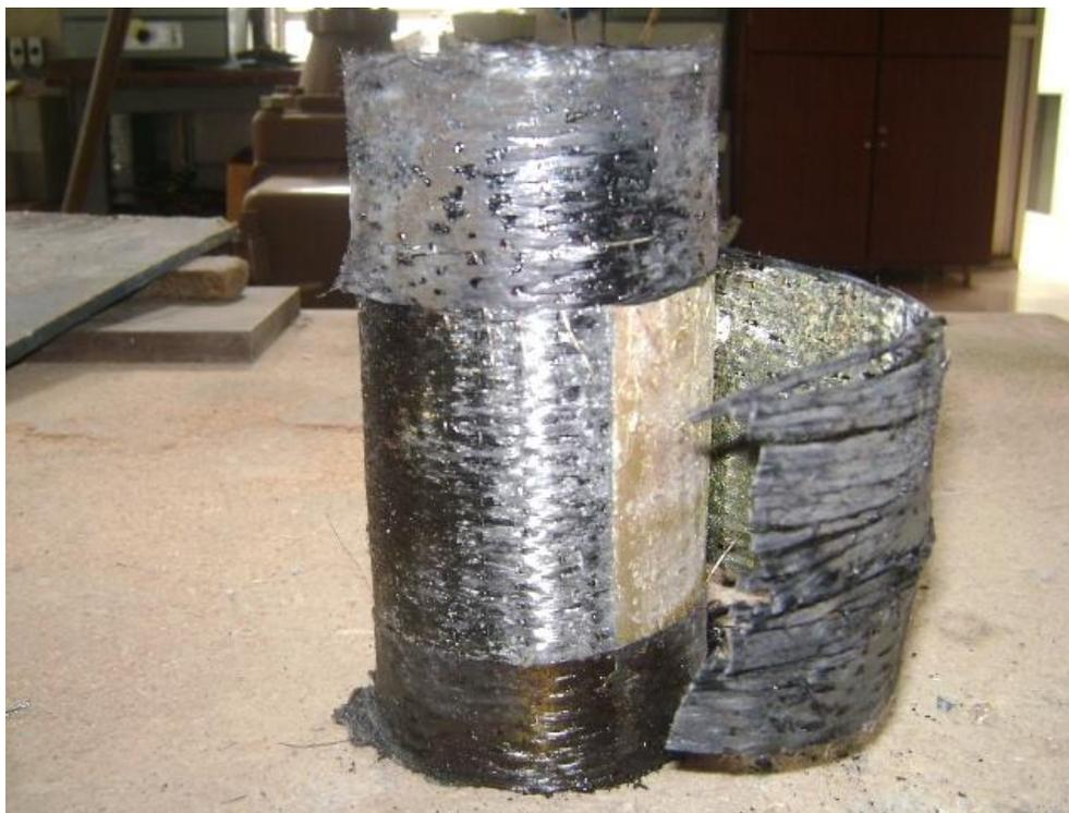
**Figura 11.5** – Detalhe da interface do compósito do corpo de prova exposto ao incêndio-padrão
