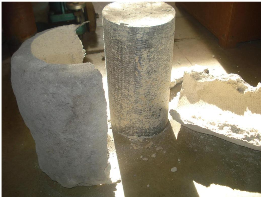
**Figura 11.23** – Corpo de prova aquecido a 500 °C (Protegido com argamassa)
