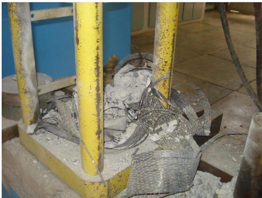
**Figura 11.28** – Rompimento do corpo de prova aquecido a 1050 °C (*Spalling* na ruptura)
