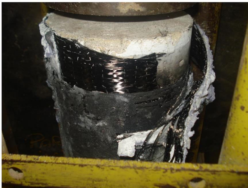
**Figura 11.15** – Corpo de prova aquecido a 1050 °C (detalhe da fibra não sublimada)
