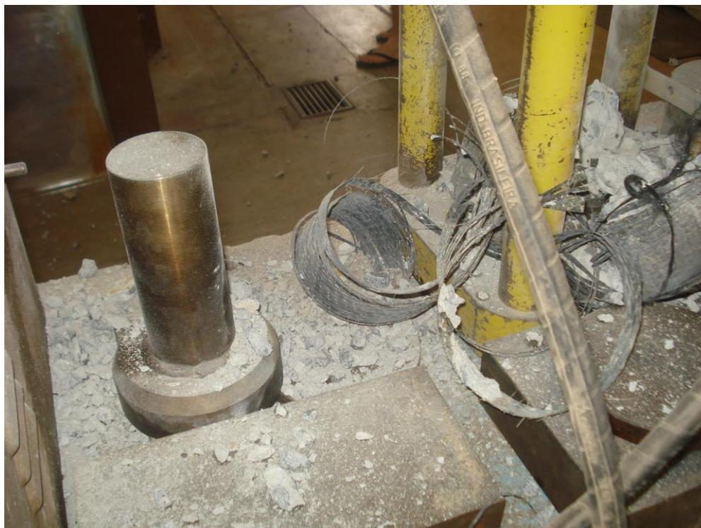
**Figura 11.29** – Fragmentos do corpo de prova aquecido a 1050 °C
