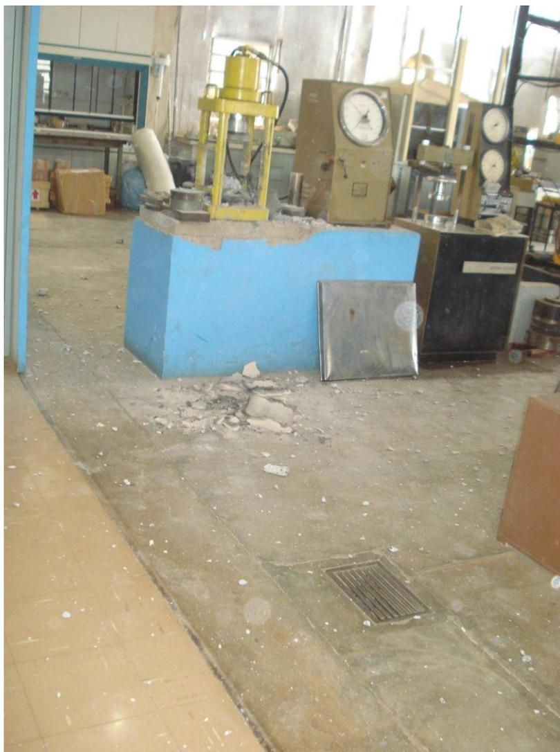
**Figura 11.30** – Estilhaços do corpo de prova aquecido a 1050 °C
