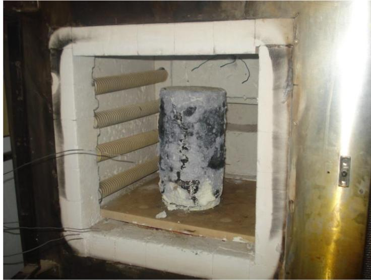
**Figura 11.13** – Corpo de prova aquecido a 1050 °C (detalhe dos aspectos embranquecido da tinta, provenientes de queima do sistema de proteção)
