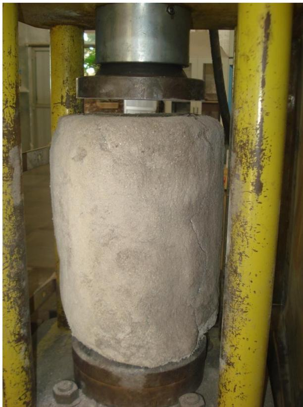
**Figura 11.24** – Corpo de prova aquecido a 700 °C (Protegido com argamassa)
