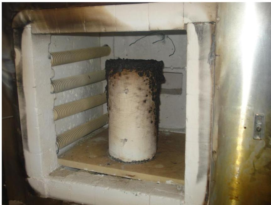
**Figura 11.7** – Corpo de prova aquecido a 600 °C (protegido com tinta)
