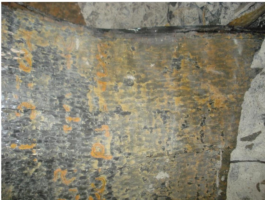
**Figura 11.17** – Aspecto amarelado da resina em estado gelatinoso após o ensaio a 800 °C (protegido com tinta)
