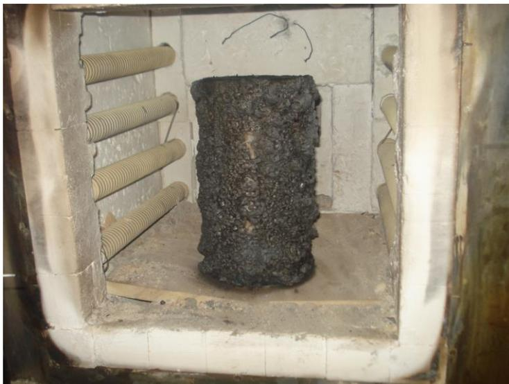
**Figura 11.9** – Corpo de prova aquecido a 700 °C (protegido com tinta)
