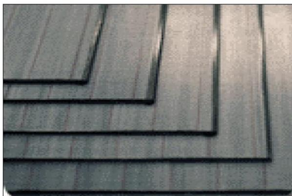
**Figura 2.1** – Sistema de reforço com chapas pultrudadas [LIMA (2001)]
