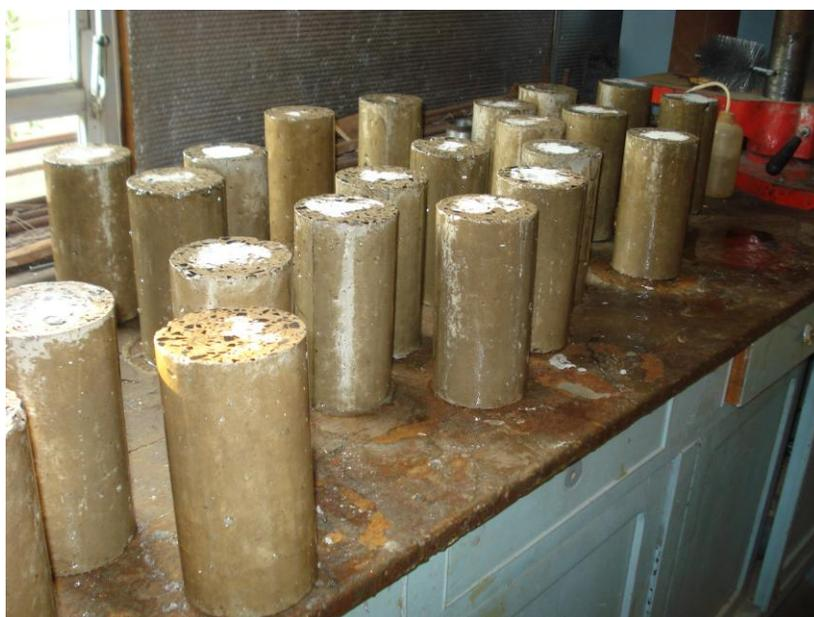
**Figura 9.2** – Amostras com superfícies impermeabilizadas
