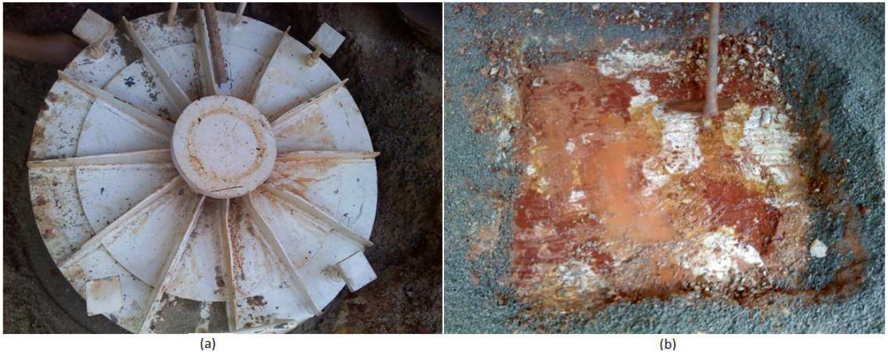
Figura 5.15: (a) Placa metálica de 0,5m^2 e (b) nivelamento do solo de apoio da placa.
