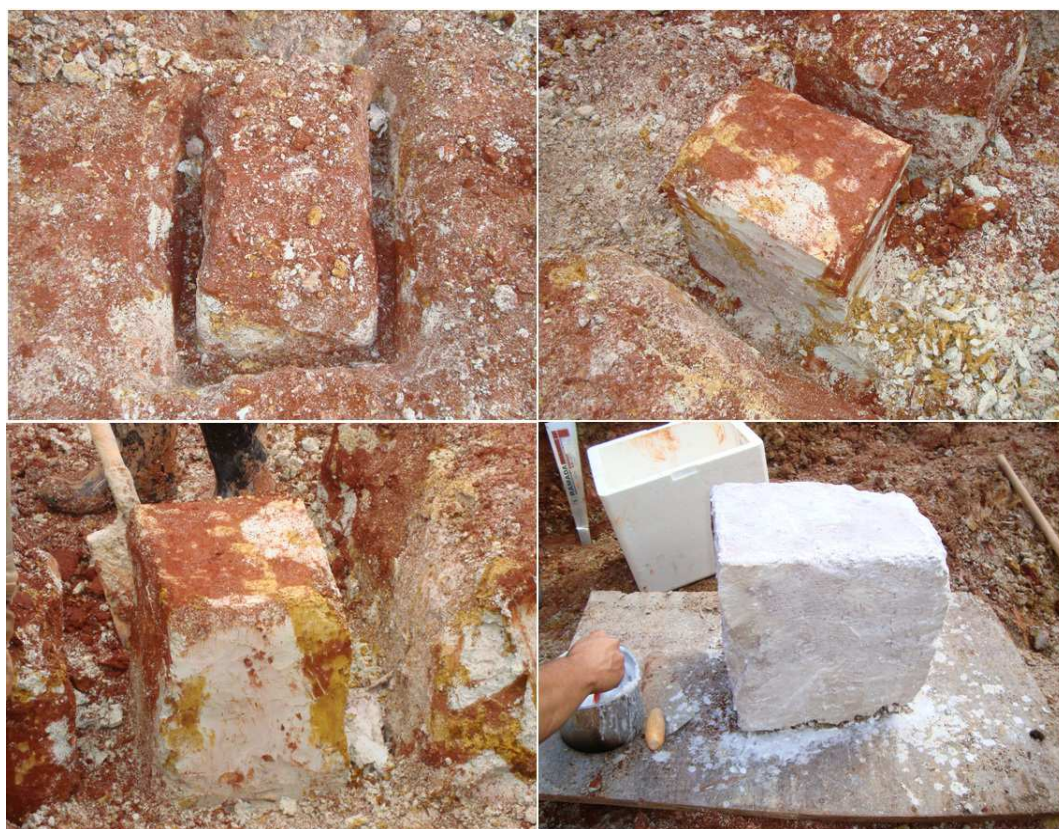
Figura 5.4: Etapas da retirada de amostra indeformada.
