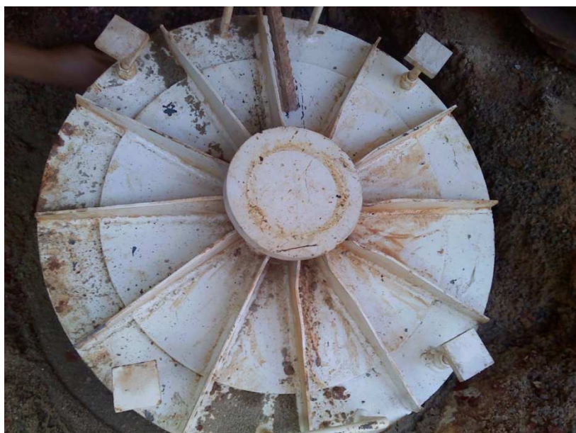
Figura 6.24: Placa do ensaio com reforços radiais.
