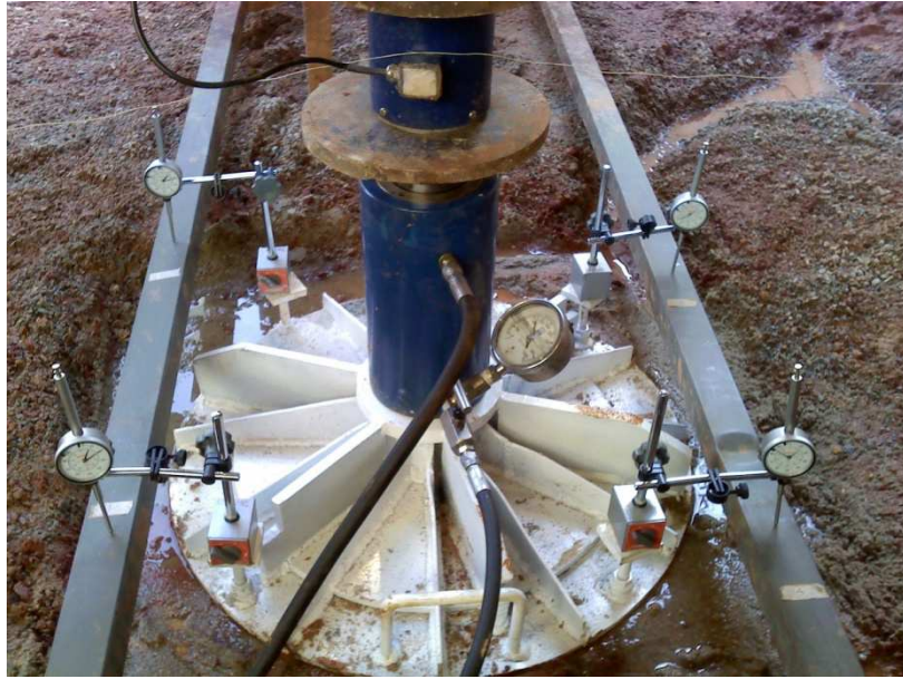
Figura 5.19: Quatro extensômetros dispostos diametralmente em oposição.
