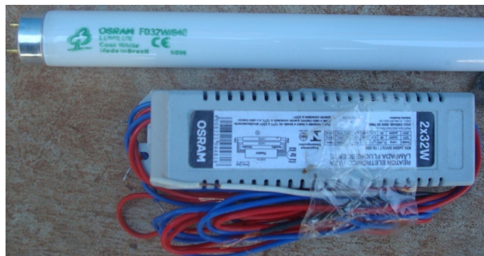
Figura 30 – Lâmpada e Reator utilizados no salão principal de vendas do hipermercado B.
