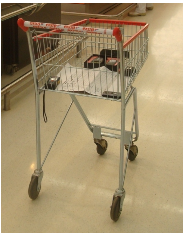
Figura 34 – Equipamentos utilizados para medição de iluminâncias.
