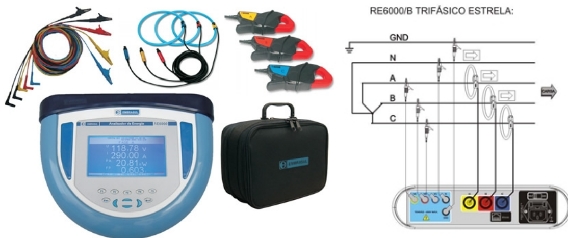
Figura 32 – Analisador de Energia Embrasul RE 6000 e sua conexão à rede.
