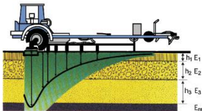
Figura 2.3 – Representação esquemática da bacia de deformação obtida através do equipamento FWD (BERNUCCI et al., 2008)
