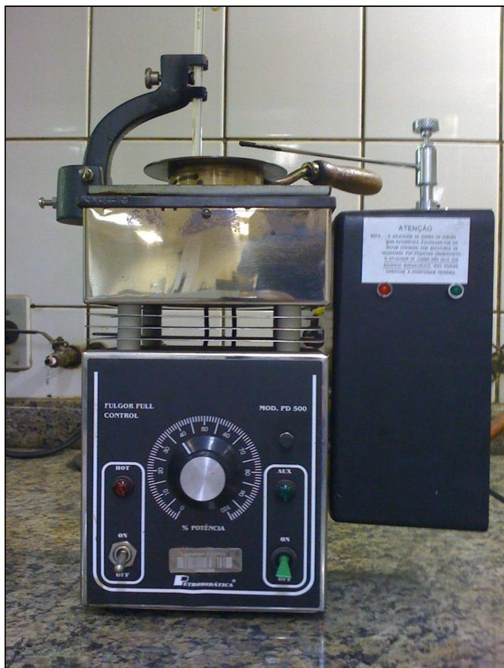
Figura 4.7.1.6 - Equipamento para determinação dos pontos de fulgor e de combustão em vaso aberto Cleveland
