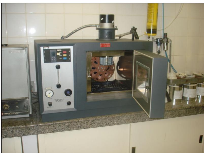
Figura 4.7.1.7 - Equipamento para determinação do efeito de calor e ar em uma película delgada rotacional (RTFOT)
