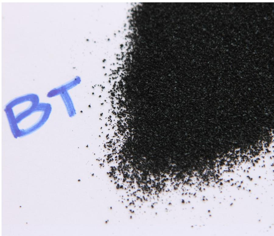
Figura 6.1 - Desaglomeração do pó de borracha tratado com hidróxido de sódio
