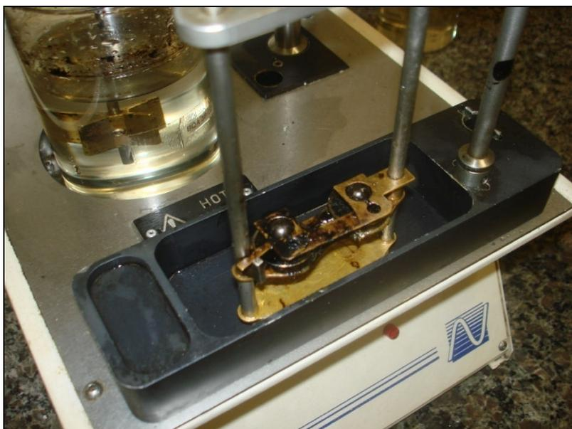
Figura 4.7.1.5 - Equipamento para ensaio de separação de fases (estabilidade a estocagem)
