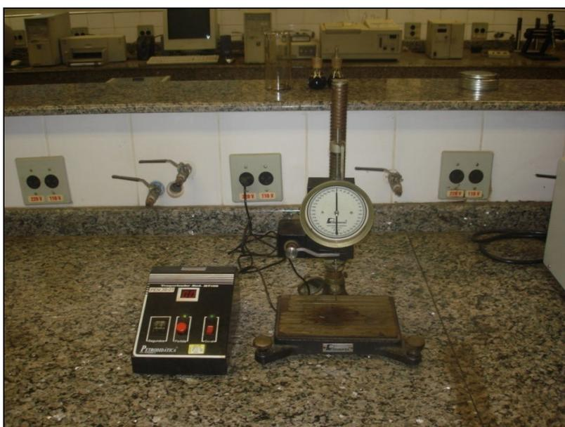
Figura 4.7.1.2 - Equipamento para ensaio de penetração
