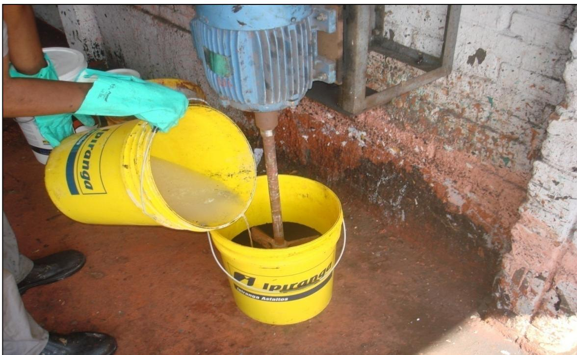
Figura 4.2.1 - Processo de tratamento com solução saturada de NaOH
