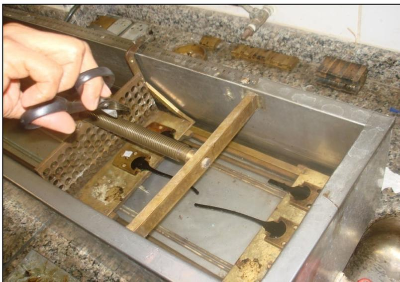
Figura 4.7.1.4 - Ensaio de recuperação elástica *Ductilomêtro*
