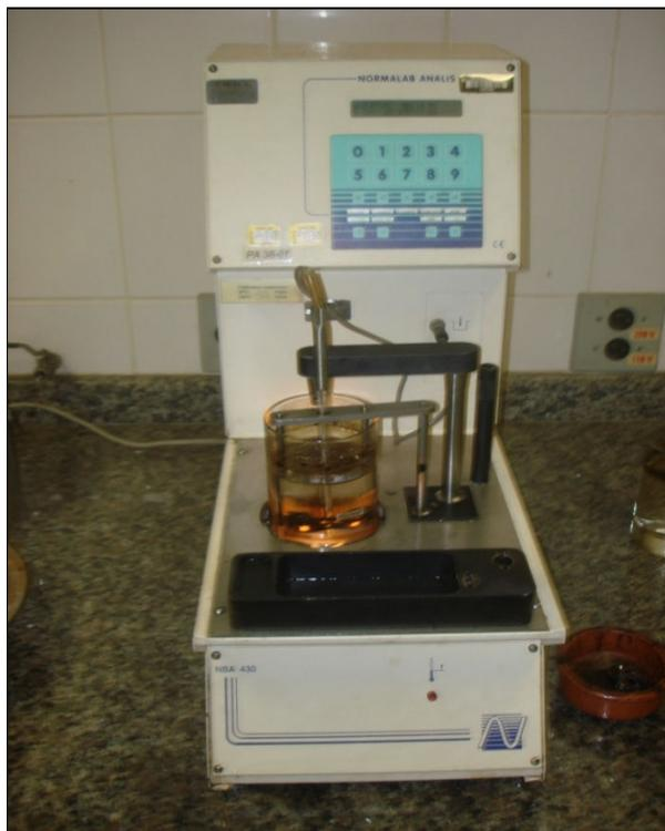
Figura 4.7.1.1 - Equipamento de ensaio para determinação do ponto de amolecimento (método do anel e bola)
