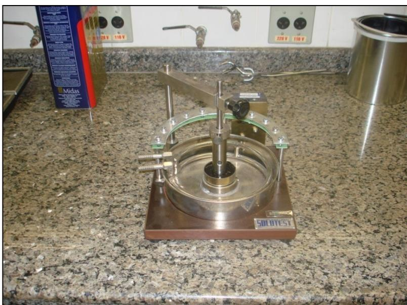
Figura 4.7.1.3 - Equipamento viscosímetro rotacional Brookfield
