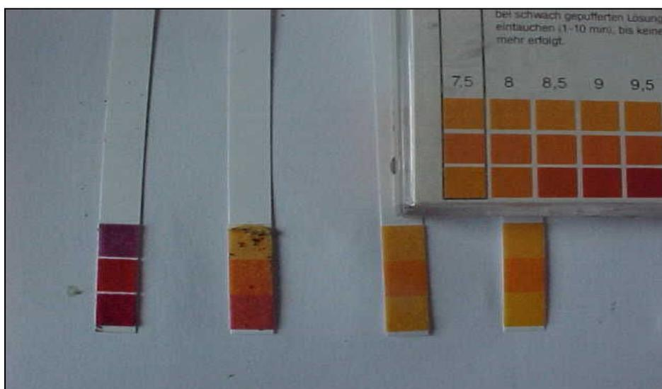
Figura 4.2.3 - Papel indicador de pH em contato com a água do pó de borracha após lavagem
