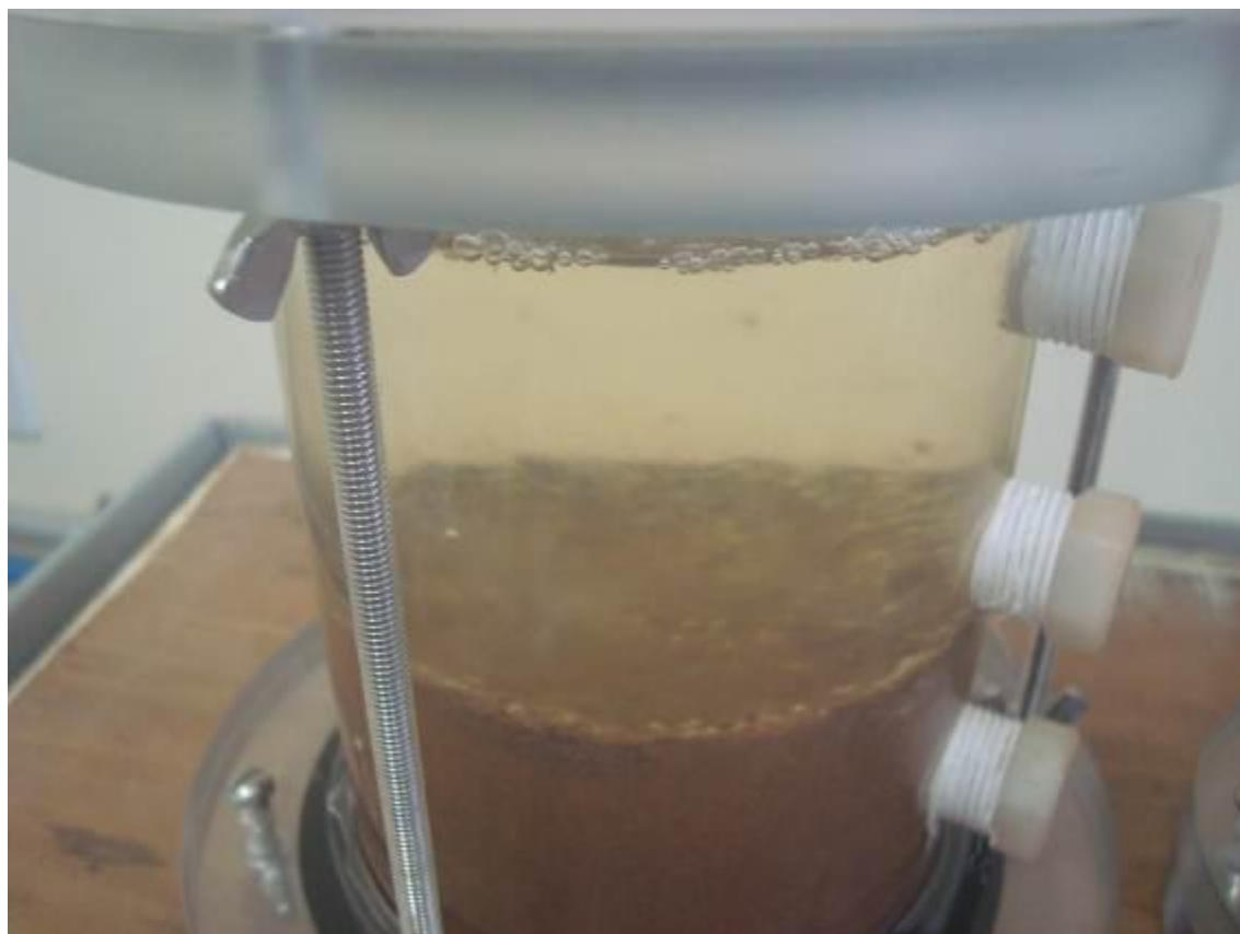
Figura 5.60. Bolhas de ar no topo do corpo-de-prova devido à atividade biológica.
