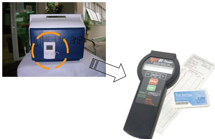
Figura 4. Turbo Tag: cartão RFID para monitoramento de temperatura e leitor portátil.
