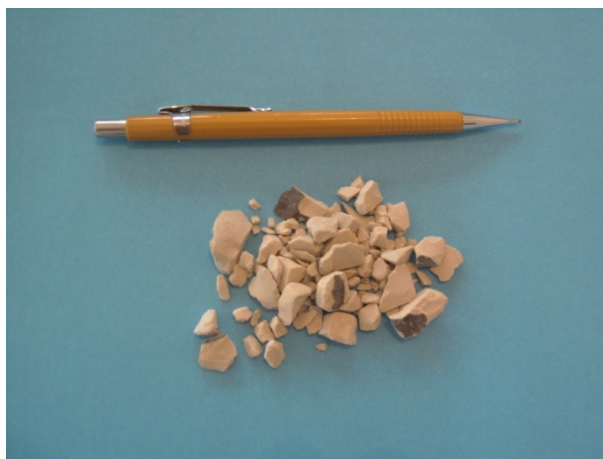
Figura 4.9 – Agregado graúdo alternativo, porcelana graúda.
