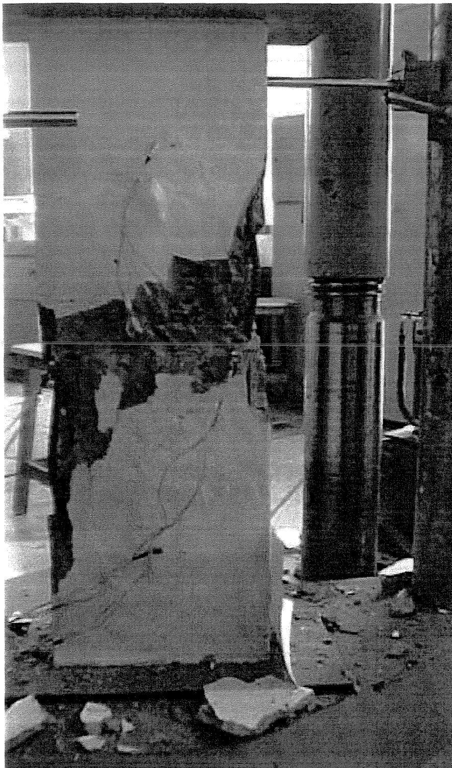
Figura 3.27 – Detalhe da ruptura do modelo P2 – Costas
