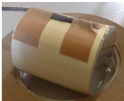
Figura 6-7: Fixação dos sensores
