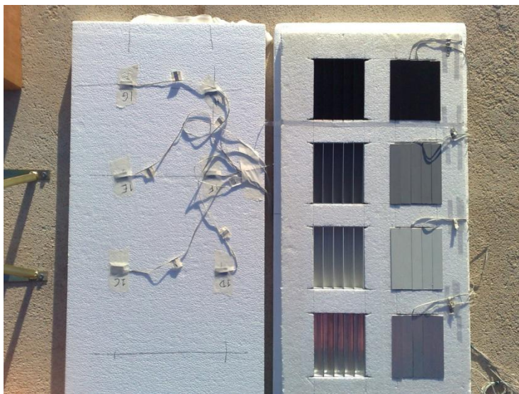
Figura 5-12: Sensores sob o isolante durante a montagem.
