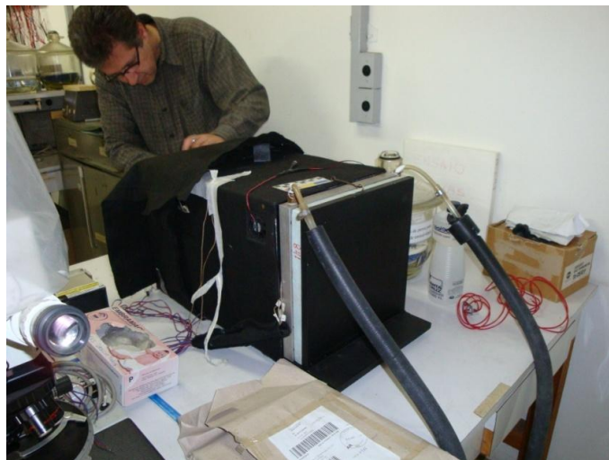
Figura 3-18: Procedimento de referência JIS A 1423:1983 no IPT
