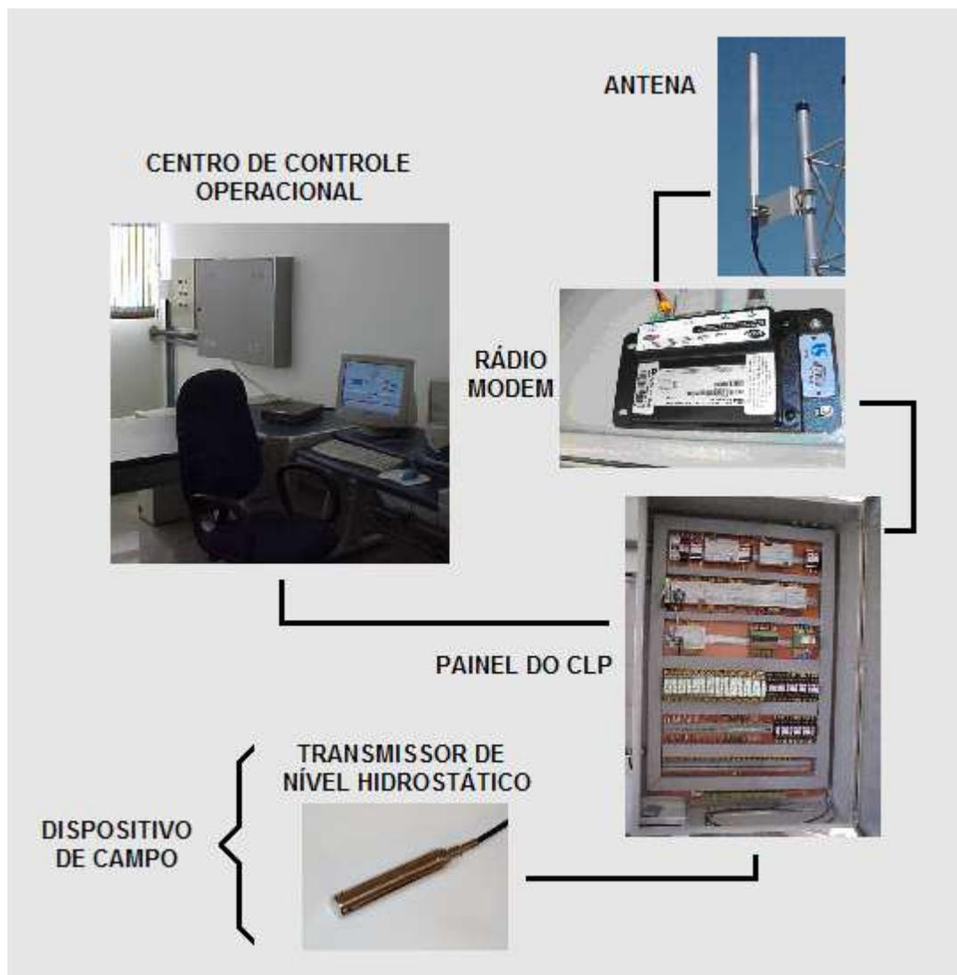
**Figura 4.13 – Configuração da unidade remota da Zona Alta (Estação de Tratamento de Água) – Fonte: Autor, 2011.**
