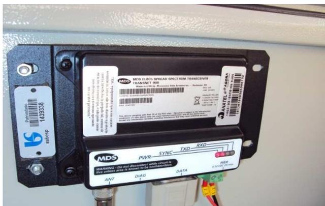
**Figura 4.11 - Rádio-modem de 900 MHz, marca MDS, modelo TransNET900 –
