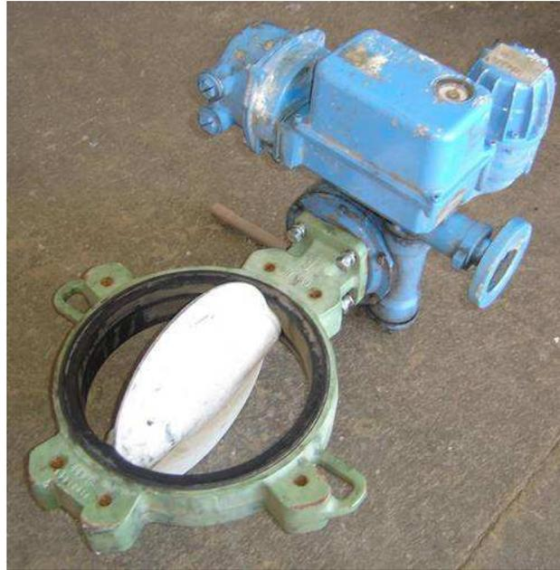
**Figura 4.10 - Válvula Motorizada – Fonte: Autor, 2010.**
