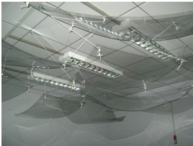
Figura 5.6 - Câmara reverberante com os difusores suspensos.
