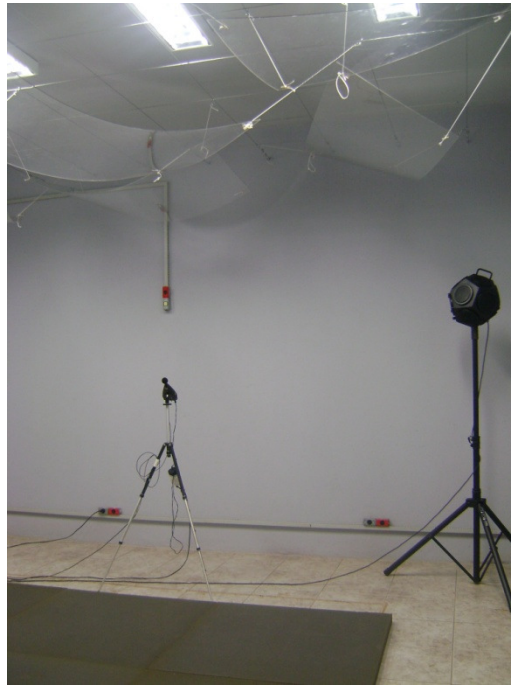
Figura 5.9 - Câmara reverberante com a configuração final dos difusores e amostra de teste.
