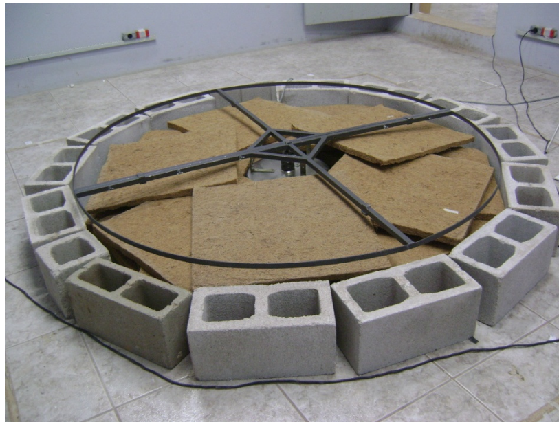
Figura 4.3 - Cinturão de blocos de concreto e placas de fibra de coco embaixo da mesa giratória.
