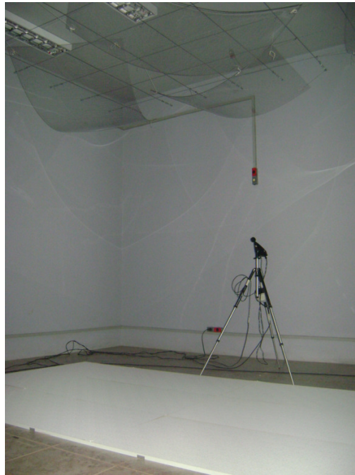
Figura 5.10 - Painéis de lã de vidro dentro da câmara reverberante.
