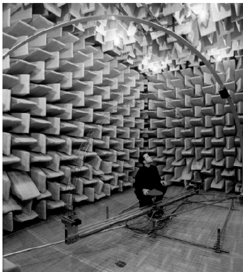
Figura 2.6 - Sistema de determinação do coeficiente de difusão sonora com goniômetro 3D, (University of Salford).
