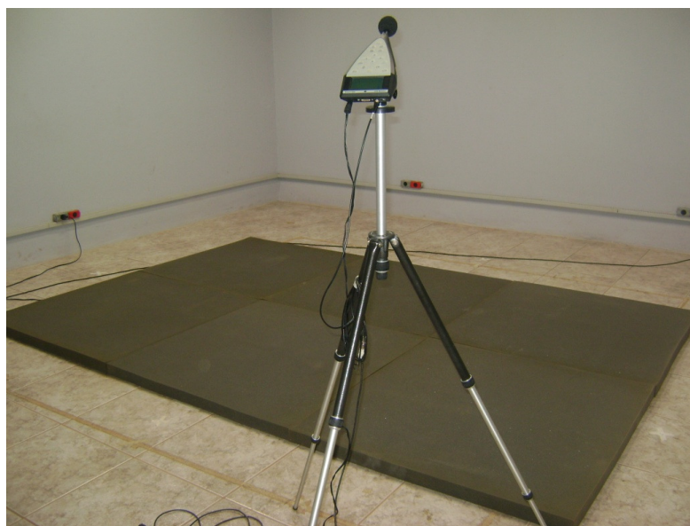
Figura 5.4 - Amostra de espuma de poliuretano dentro da câmara reverberante
