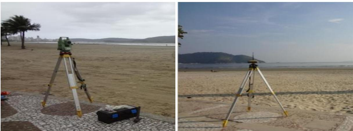
**Figura 29:** Estação total (à esquerda) e equipamento GNSS (à direita).
