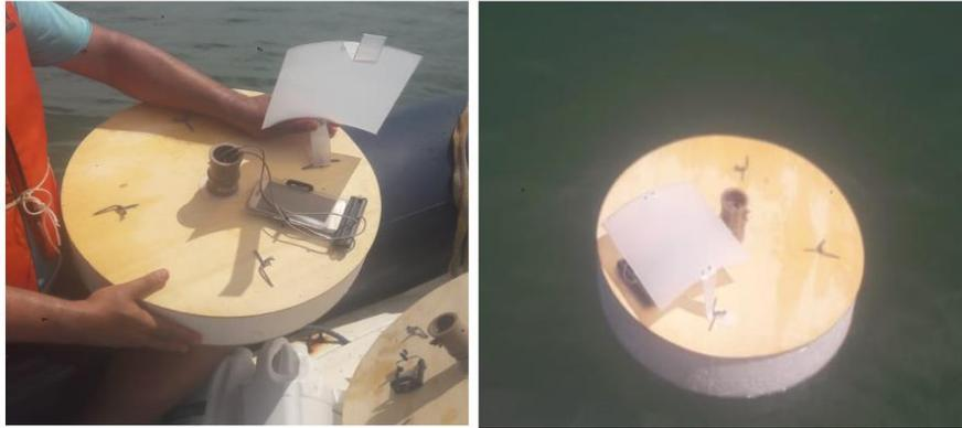
**Figura 33:** Aparato de medição (Flutuador + Smartphone).
