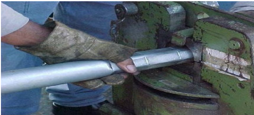
Fig.8.9 Prensagem da luva de alumínio mostrando as marcas limites do fabricante
