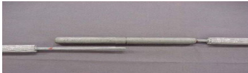
Fig. 8.4 b Marcas para centralizar a luva de aço no cabo
