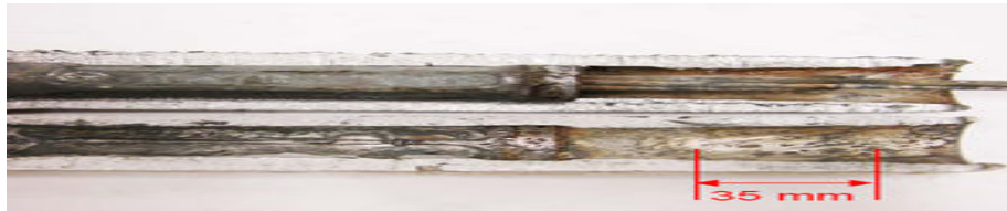
Fig. 4.26 Extremidade rompida e dimensão do cabo de alumínio dentro da luva
