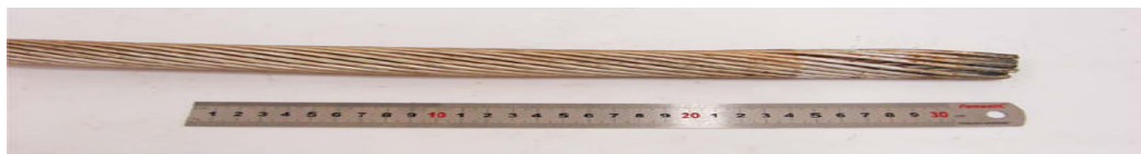
Fig. 4.18 Cabo rompido em campo (medida do cabo dentro da luva de alumínio)
