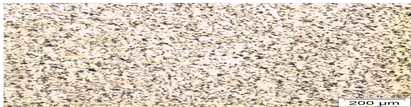
Fig. 4.12 Microscopia óptica do cabo de aço, corte transversal, aumento de 50x, (onde a cor escura indica a presença de carbono e a clara a de alumínio)
