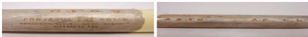
Fig. 4.19 Identificação na luva de alumínio (fabricante, matriz e rastreabilidade de montagem)
