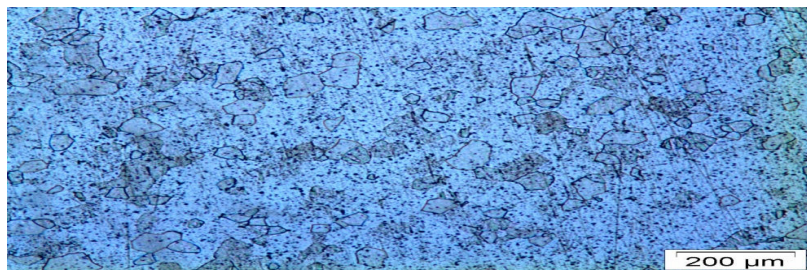
Fig. 4.6 Microscopia óptica luva de alumínio, corte transversal, aumento de 50 x;
