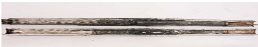
Fig. 4.23 Corte da luva de alumínio para visualização e análise da qualidade
