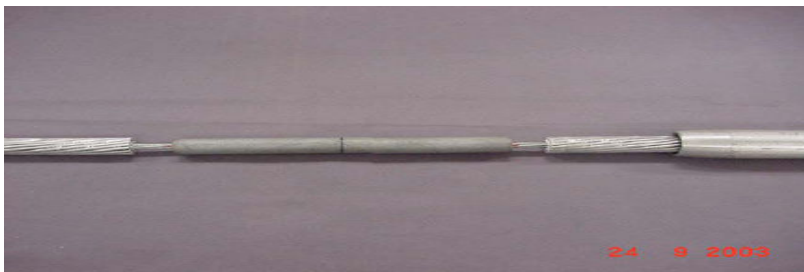
Fig. 8.4 c Marcas para centralizar a luva de aço no cabo
