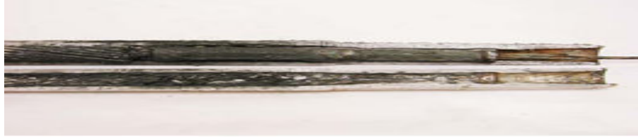
Fig. 4.25 Detalhe da extremidade rompida e Corte da luva de alumínio
