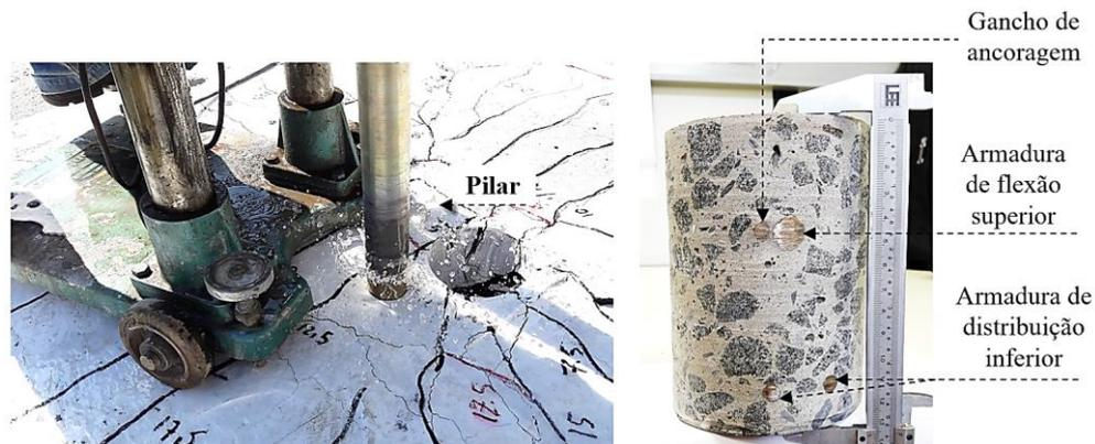
**Figura 4.3 - Extração e modelo de corpo de prova das lajes ensaiadas**
