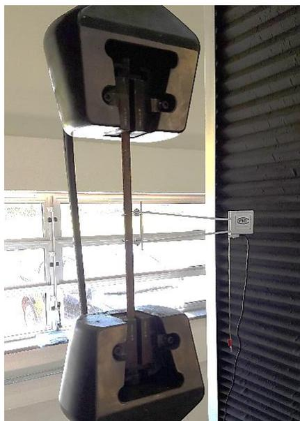
Figura 5.4 - Ensaio de tração axial da barra de aço com diâmetro de 12,5 mm
