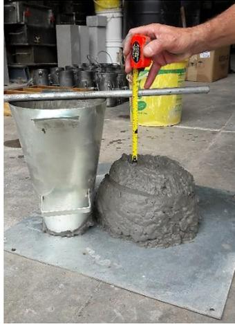
**Figura 4.6 - Ensaio de abatimento do tronco de cone**
