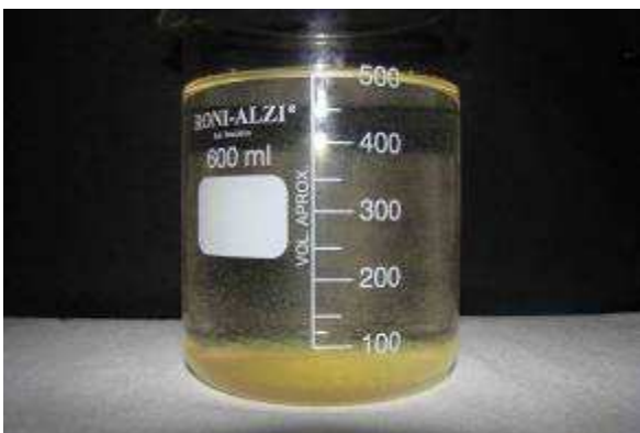
Figura 132: Decantação no ensaio de tratabilidade, 10 minutos – ETA Rio Solimões
