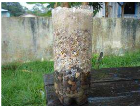
Figura 69: Camadas de granulometrias decrescentes para suporte areia dos FLs
