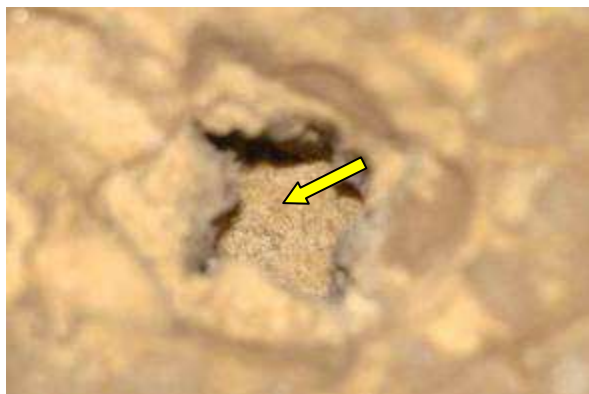
Figura 123. Vista da camada de areia inferior (abaixo do schmutzdecke inferior)– ETA Rio Negro
