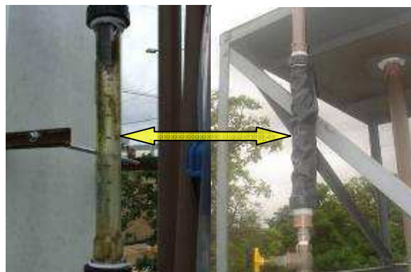
Figura 65: Formação de lodo e capa confeccionada para o rotâmetro
