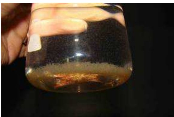
Figura 134: Decantação no ensaio de tratabilidade, 15 minutos – ETA Rio Solimões
