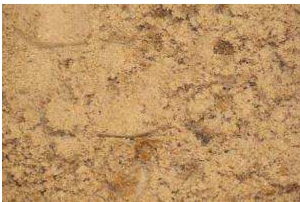
Figura 90: Aparência a areia do FL após o revolvimento na ETA Rio Negro
