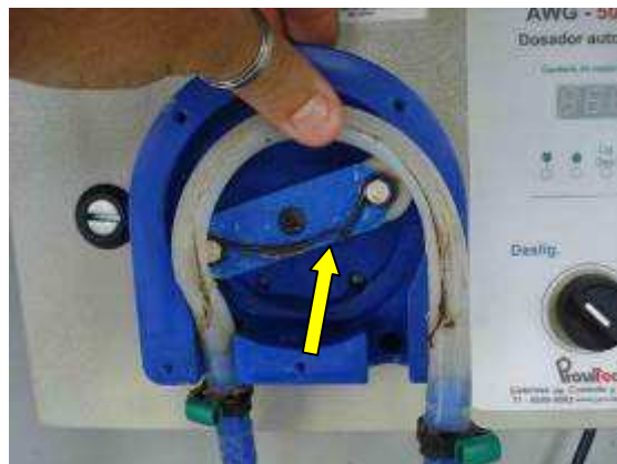
Figura 75: Quebra do grampo do eixo de rotação da bomba peristáltica
