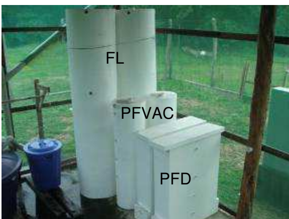
Figura 49: FL, PFVAC e PFD das ETAs fabricados
