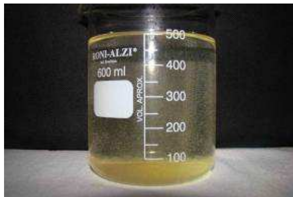
Figura 131: Decantação no ensaio de tratabilidade, 5 minutos – ETA Rio Solimões
