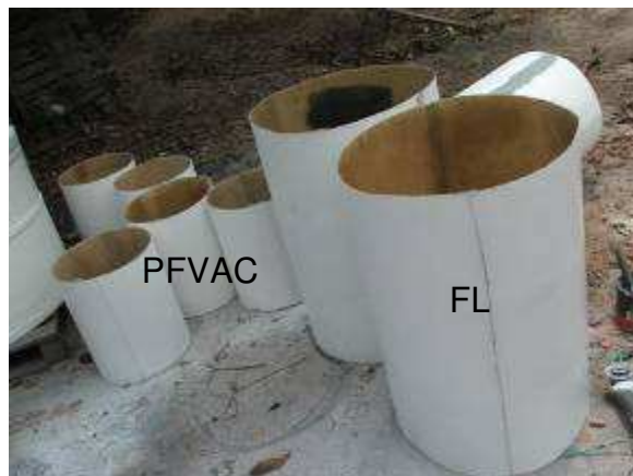
Figura 48: Fabricação do PFVAC e do FL das ETAs
