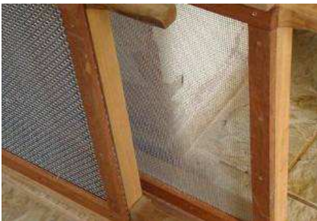
Figura 70: Peneiras de seleção do material granular para complementação do PFD
