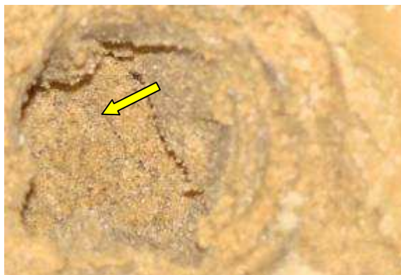
Figura 143. Vista da camada de areia inferior (abaixo do schmutzdecke inferior)– ETA Rio Solimões
