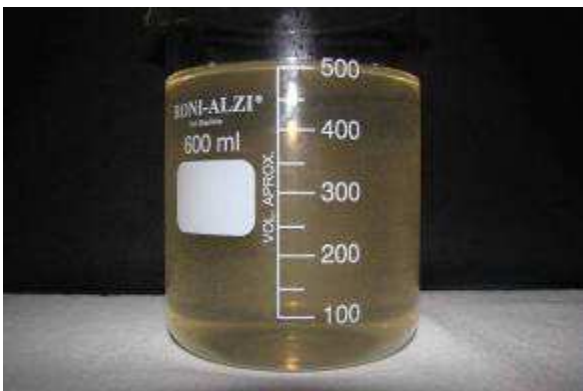
Figura 130: Final da floculação no ensaio de tratabilidade – ETA Rio Solimões
