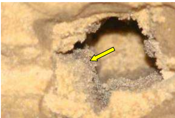
Figura 122. Vista do schmutzdecke inferior (abaixo da camada de areia)– ETA Rio Negro
